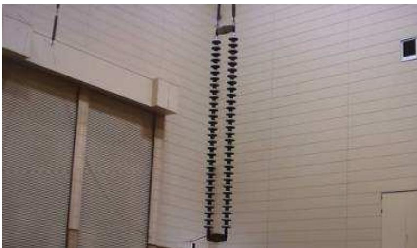
圖4：未加壓狀態待測絕緣碍子
