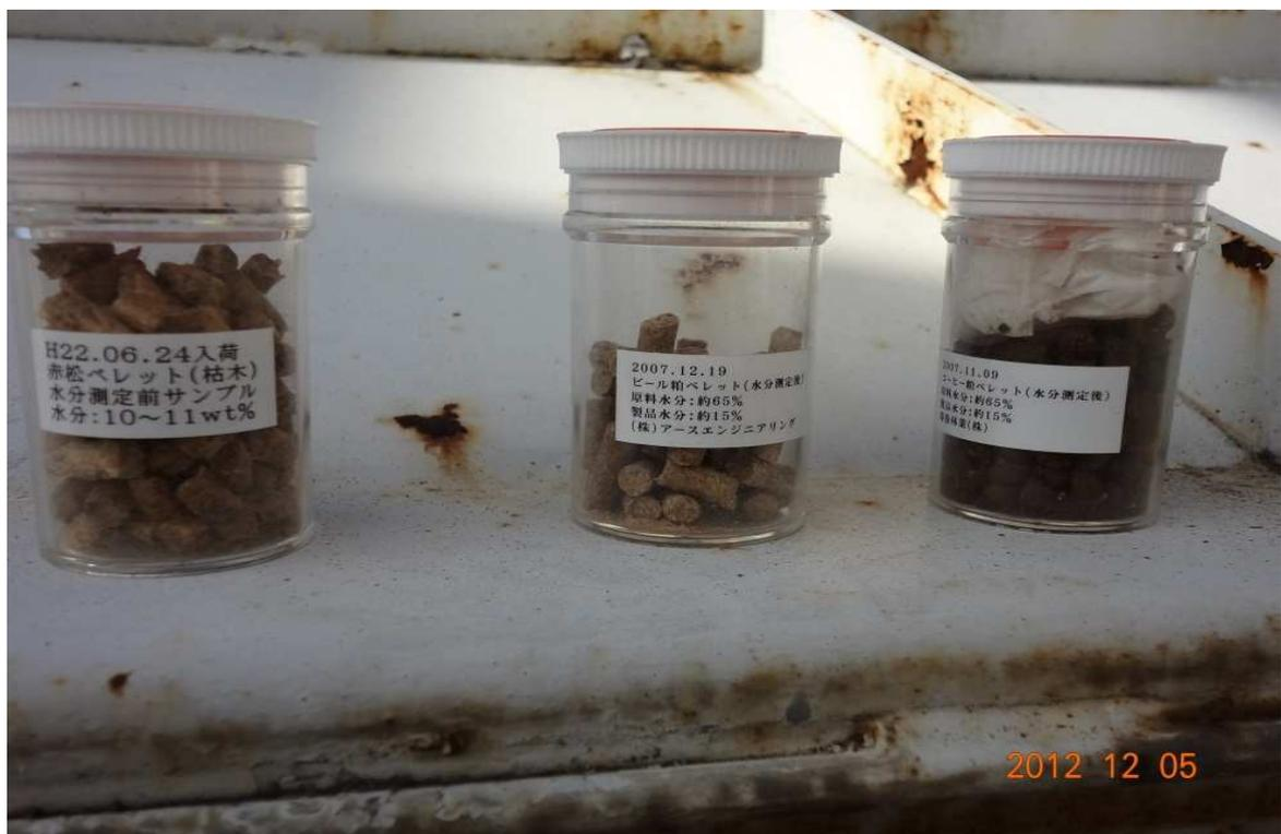
圖 5：CRIEPI 碳化與氣化系統實驗料源(紅松木、咖啡渣)
