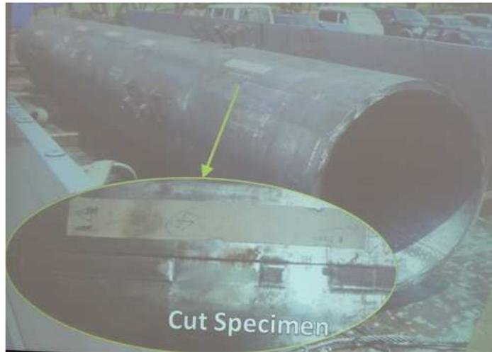
圖 6：非破壞性檢驗 sample 取樣
