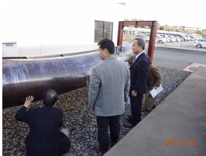
圖 7：實驗設施現場破壞測試後蒸氣管路實體與參觀解說情形
