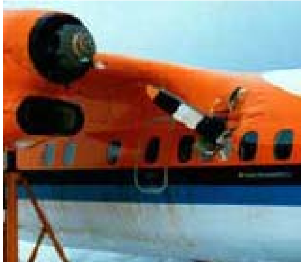
圖十六、渦輪發動機螺旋槳葉片失效後高能破片脫離實例
