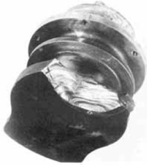
圖十八、疲勞破壞所造成斷面處海灘現象(bench mark)實例說明
