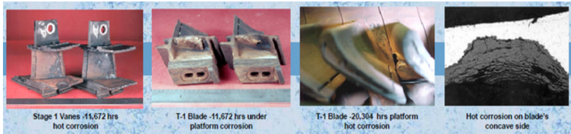
圖十四、渦輪發動機熱段熱腐蝕現象
