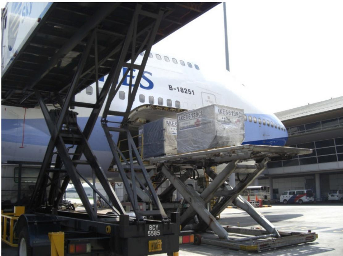
圖 7-中華航空飛機在停機坪-執行後貨艙裝載作業
