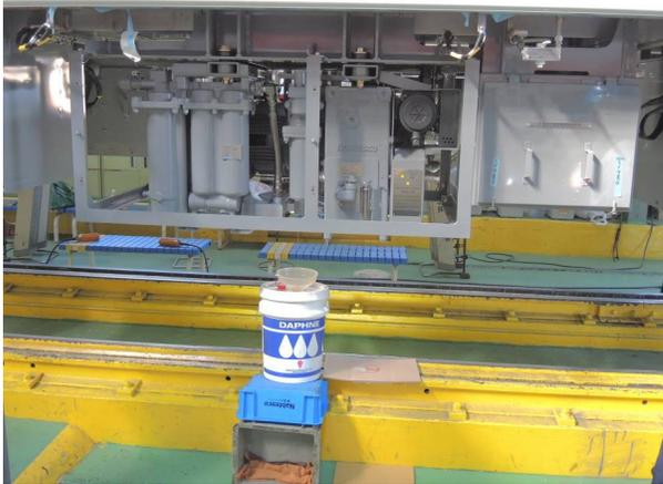
車下大型設備安裝作業
