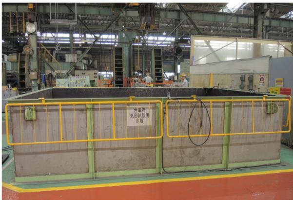
(圖四)、框總成水箱氣密測試
