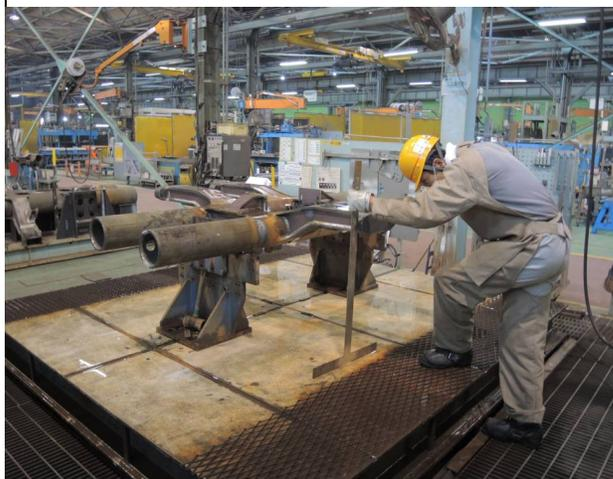
轉向架焊接應力變形檢驗作業
