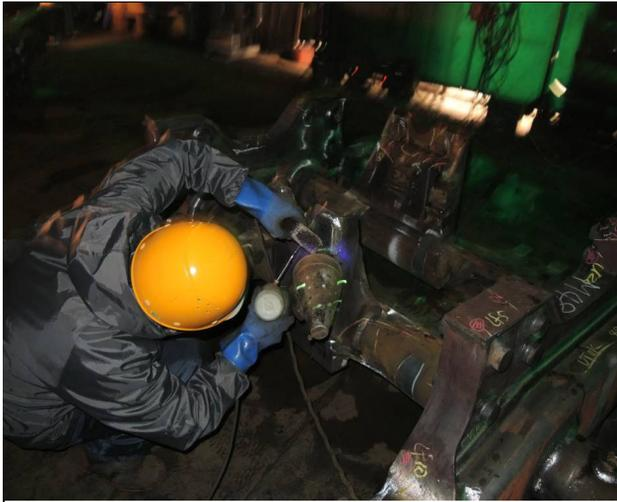
轉向架非破壞性檢驗作業
