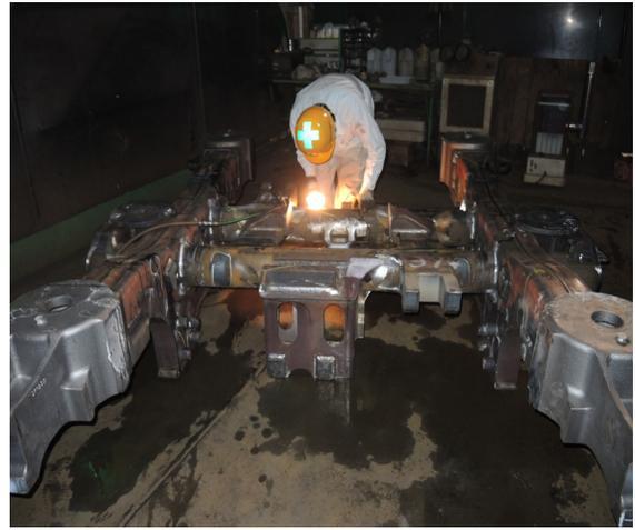
(圖三)、組合後作焊道檢查及研磨
