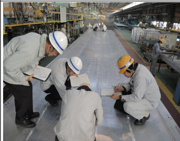
車架檢查量測作業
