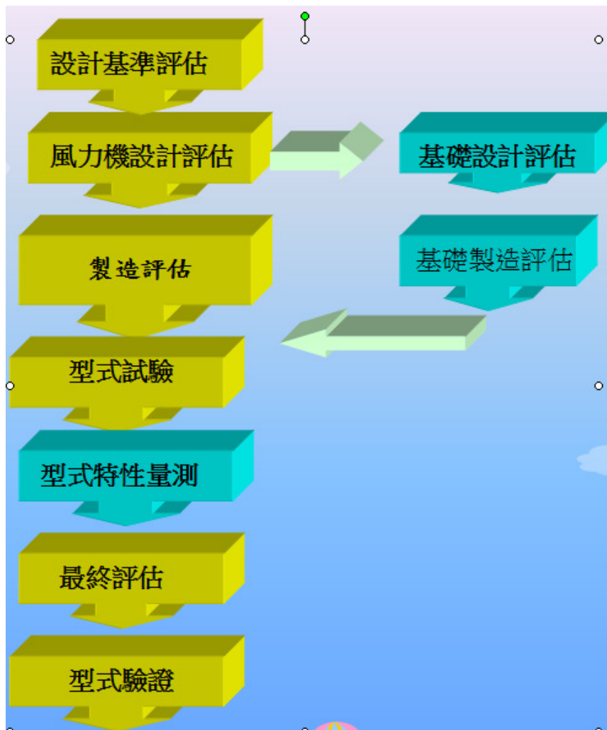
圖1 IEC 61400-22風機符合性驗證流程
