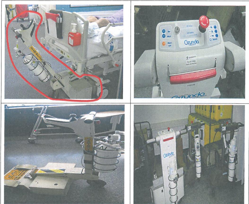
\* 推床輔助器架於床尾，操作人員只需操控機台上的大按鈕可輕易地使載有病人的病床行駛（包括直線及轉彎、最高速限、煞車紐、可攜帶氧氣筒）
