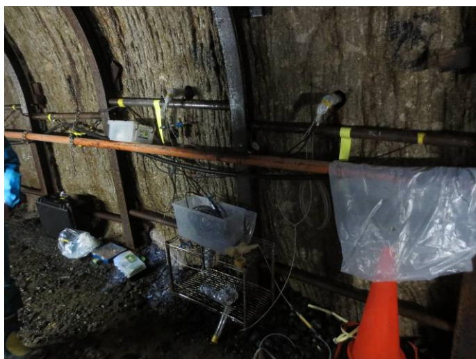
圖 37 CRIEPI 在坑道內進行的地下水氧化速率量測研究
