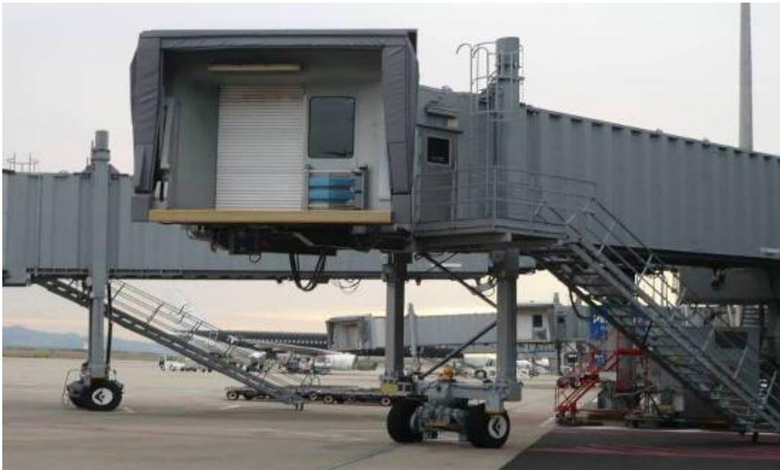
圖5-3 關西機場 空橋 (機械螺桿式升降柱)
