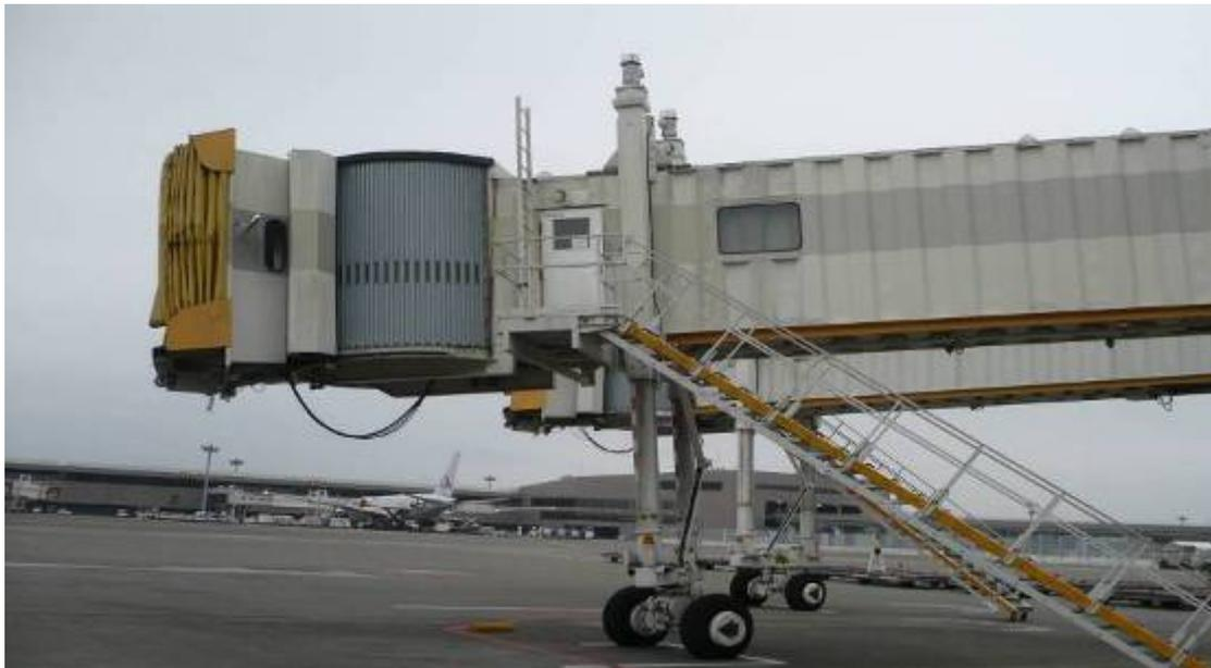
圖5-5 成田機場 空橋 (機械螺桿式升降柱+玻璃開窗)
