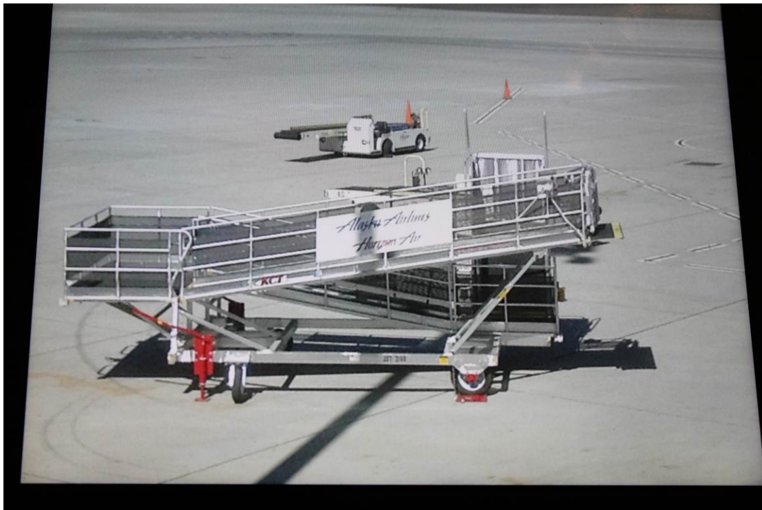
圖 36. 低成本航空提供之非動力式空橋，坡道手動調整，相較於扶梯車，此種裝備可加快旅客上下機速度，且方便輪椅及嬰兒車使用
