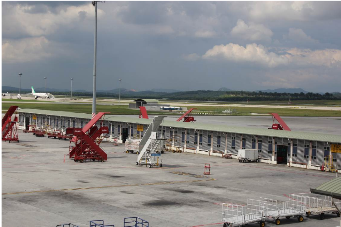
圖 33. LCCT 機坪的地勤裝備與設施：停機位皆無設置空橋，圖為旅客上下機用之梯架及行李搬運車(非動力裝備擺放區)
