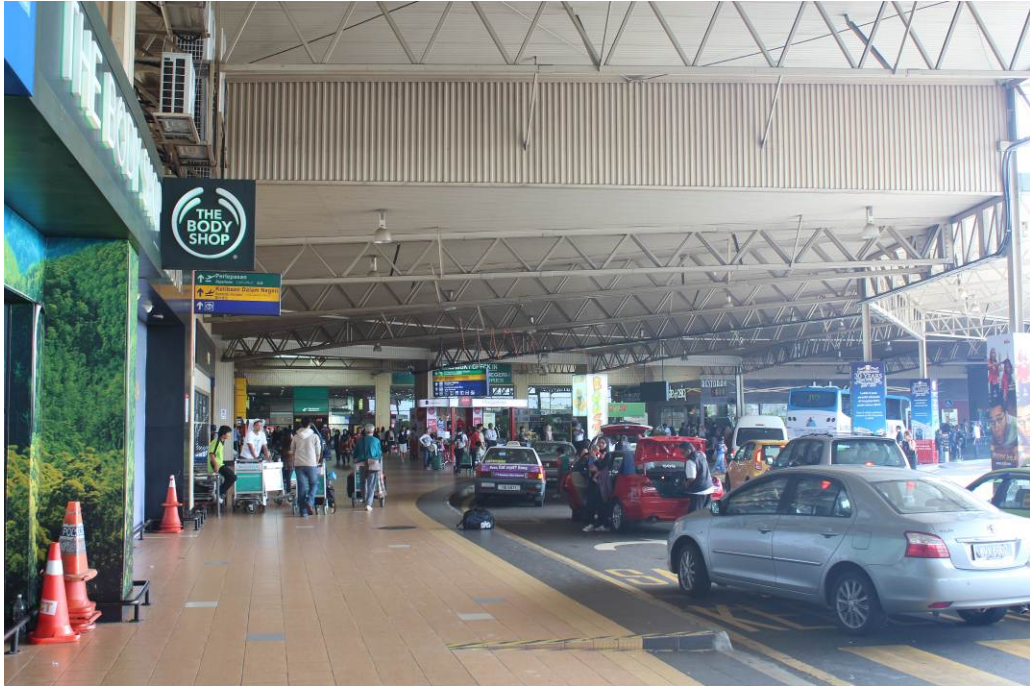
圖 4.旅客上下車處未設置月台分流出入境車流與車種，交通動線混亂
