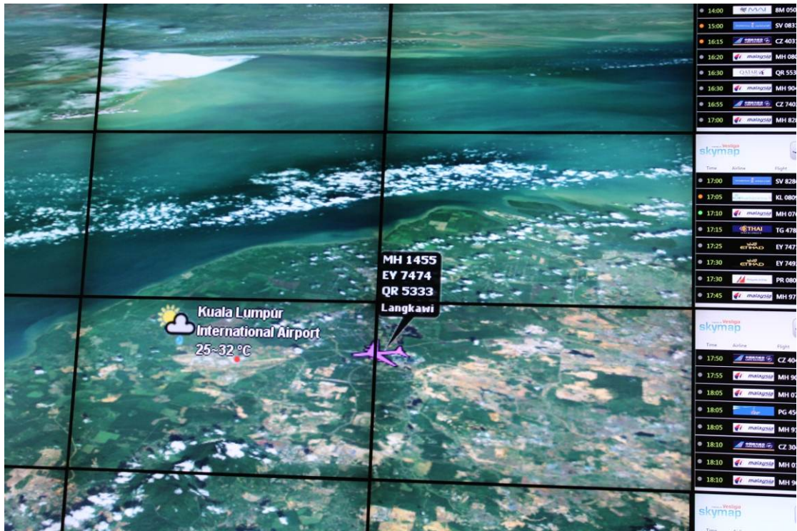
圖 39：大型 FIDS 多功能看板搭配航班即時定位系統，顯示目前航班所在位置
