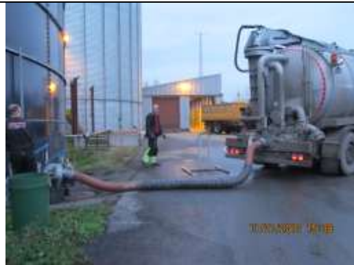
槽車運送沼渣
