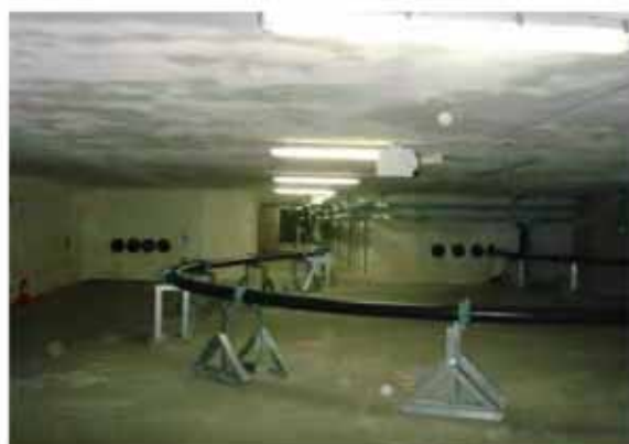
圖 5-3 左為 154kV HTS 終端匣試驗情形，右為實驗線路之佈設情形
