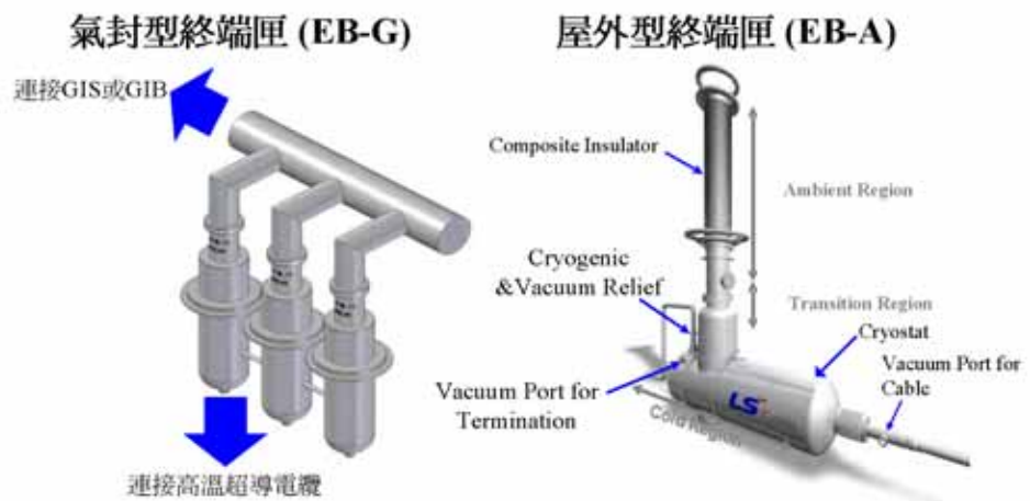
圖 3-6 高溫超導電纜終端之構造
