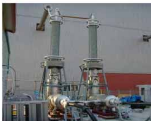
圖 5-3 左為 154kV HTS 終端匣試驗情形，右為實驗線路之佈設情形
