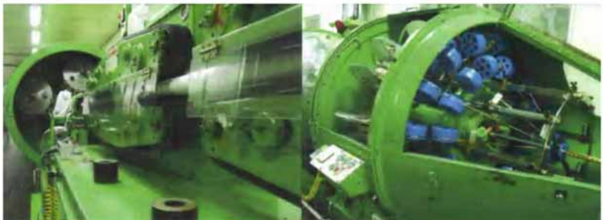
圖 4-10 LS Cable & System 高溫超導電纜的生產設備
