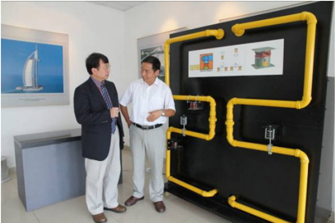
圖十一 GERB「單元調諧質量阻尼器」之減震功能展示
