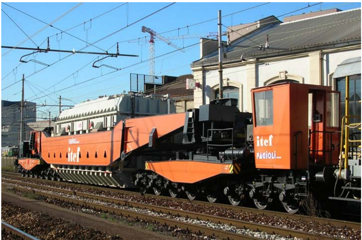
圖 25 以鐵路運方式運送變壓器
