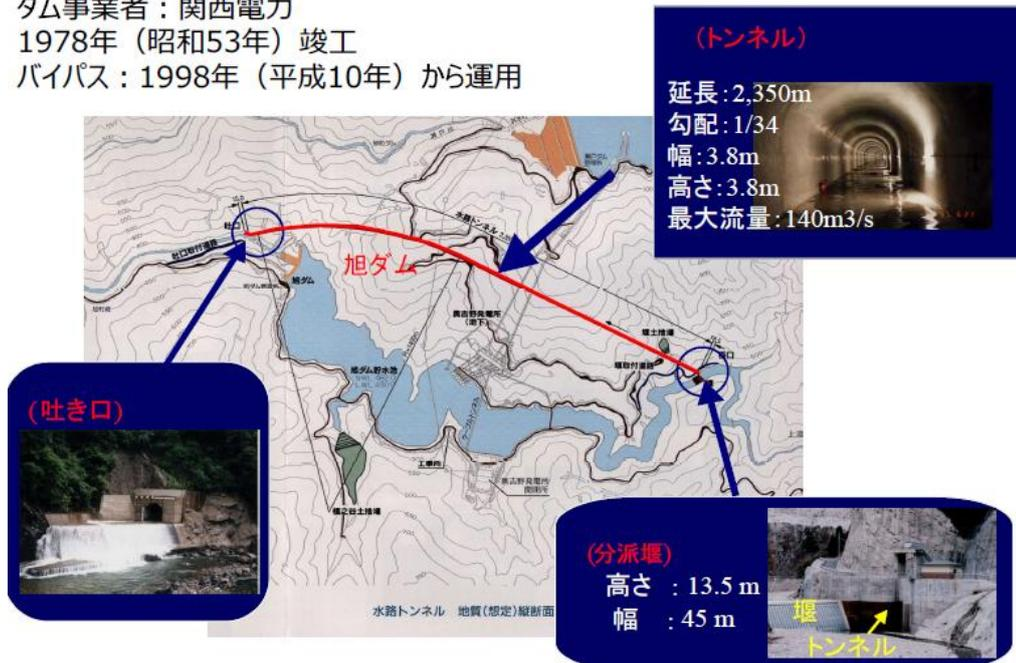
圖 4-4 旭水庫繞道排砂佈置圖
