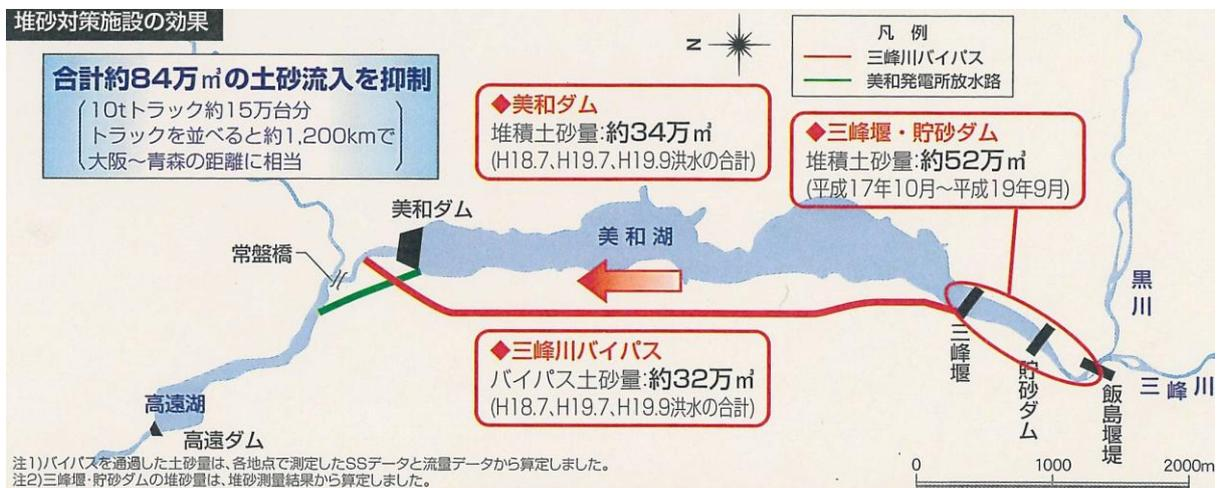
圖 4-14 美和水庫排砂隧道三場洪水事件排砂效果
