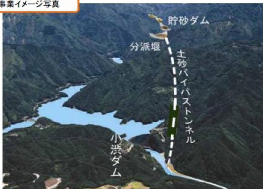
圖 4-7 小渋水庫繞道排砂佈置圖
