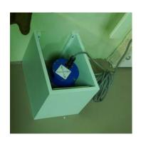
(1) 俯仰(Trim)校正:以標準的電流產生器送出 4mA,12mA,20mA 之電流信號,所對應檢測之俯仰程度為 9.67(B/S, By Stern)、0.00 Even)、9.67(B/H, By Head)三點,並比較其與實際值之誤差值是否合乎規格要求。藉由下列公式求得總精確度:
