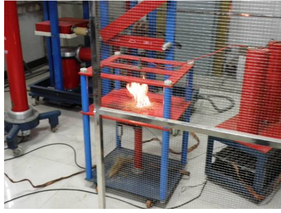
高壓電弧引燃試驗（稻草著火燃燒）
