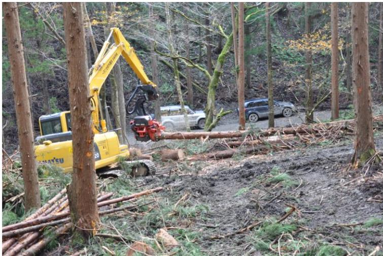
圖十六、使用功能性機械操作伐木及造材自動化
