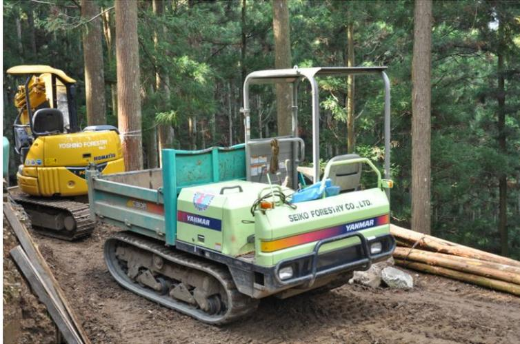
圖十二、以小型林間搬運之工程履帶車維護林間作業道
