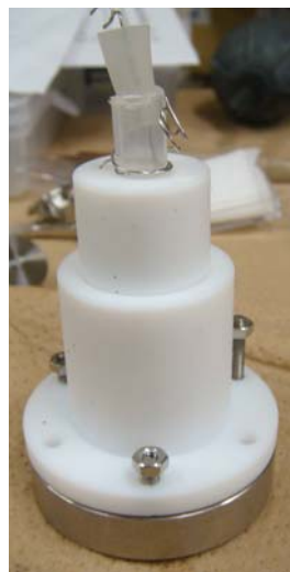
圖 5 三電極電池單元
