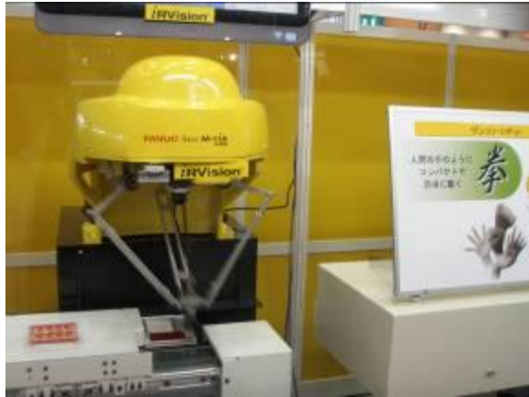
FANUC 所開發的並聯式工具機「拳」
