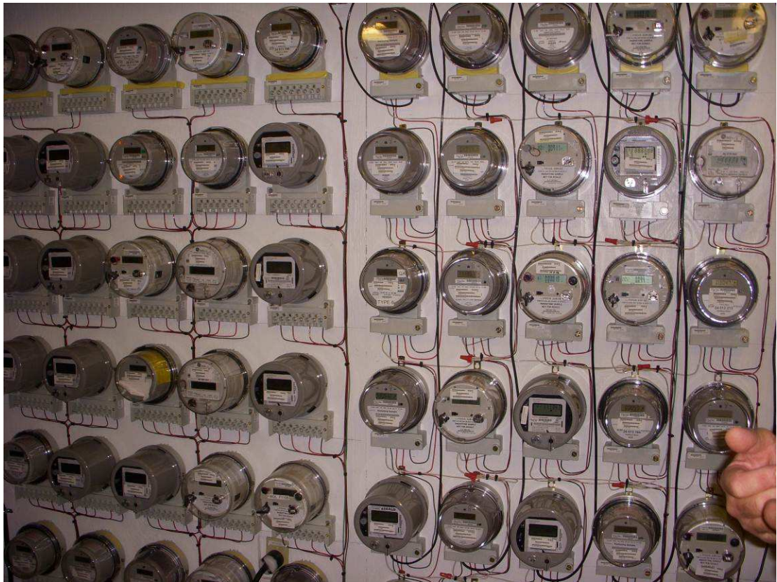
圖 13 SENSUS 電表測試平台(2)
