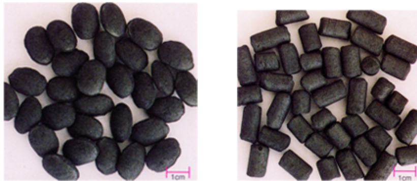
照片 4 ReACT 所用兩種活性碳,Isogo 電廠採用右圖圓塊狀
