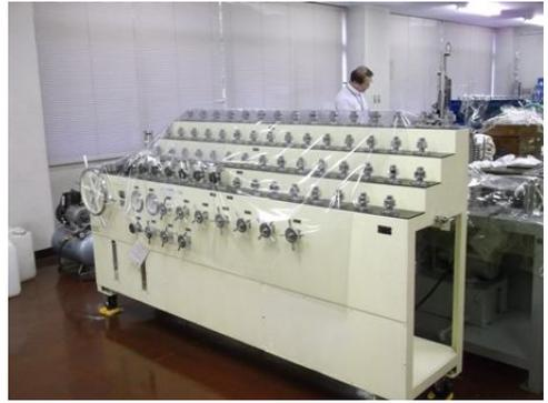
(5) 温度計検定室：体温計、温度計検定
