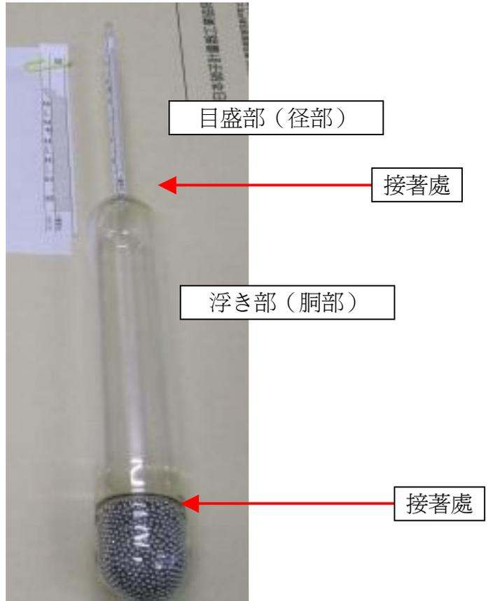
由於是手工製作，每個產品的浮動部分及目盛部都有些微的差異，所以玻璃管在接著後，要以逐一檢查，並視浮力裝填不同的重量物；在目盛部部分依比重計的浮力設計有不同長度的標示紙，每個規格的比重計就大約有 30~40 種不同的目盛紙。
