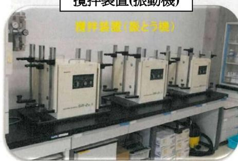
攪拌装置(振動機)
