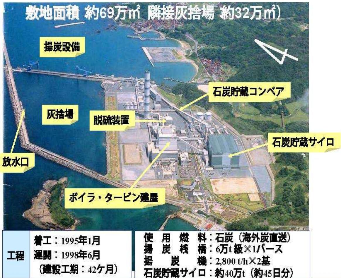
而在煤燃燒程序所產生之煤灰，可分為飛灰與底灰。一般燃煤電廠煤灰收集處理過程有多種，飛灰部分大多以靜電集塵器收集後再予處理利用，底灰則有乾式與濕式收集兩種方式，中國電力各燃煤廠產出之飛灰燒失量約為2-4%，飛灰與煤灰均視為廢棄物委由子公司依不同利用途徑作處理與利用，其方式歸類如下。 飛灰：乾式處理靜電集塵器→1灰倉（未處
