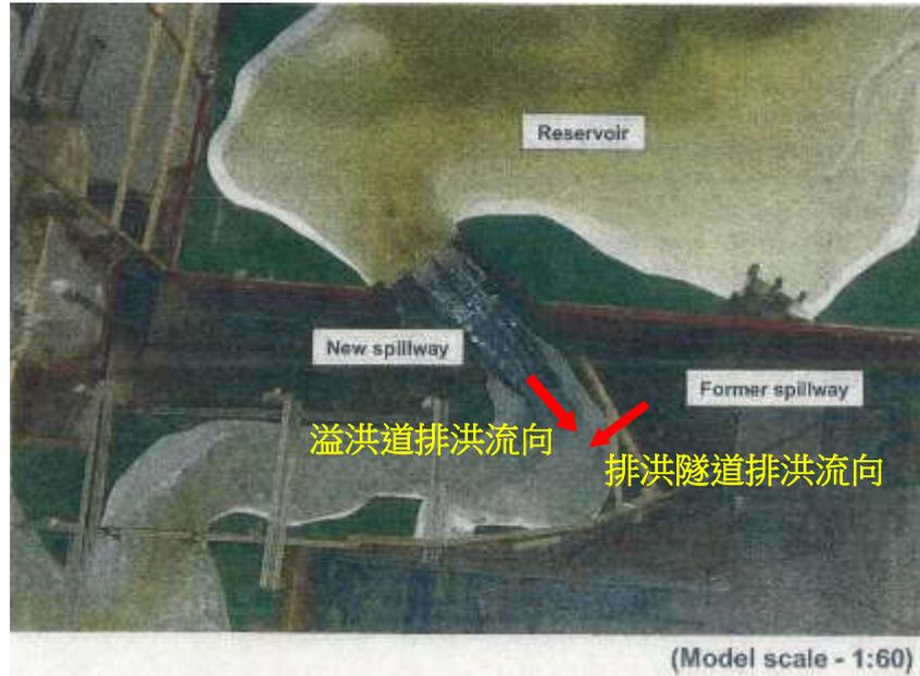
圖4-7-12 帝釋川壩改建後排洪水工模型實驗狀況
