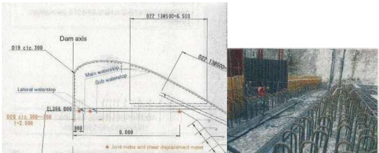
圖4-7-20 壩頂新舊混凝土接合區之補強錨筋、止水帶及監測儀器佈置圖
