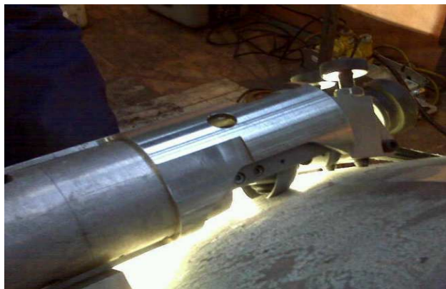
圖 7B、SPT 現場取樣情形
