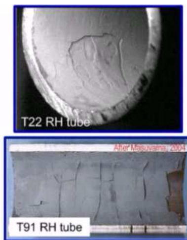
圖 11、T22與T91氧化層剝離的形態
