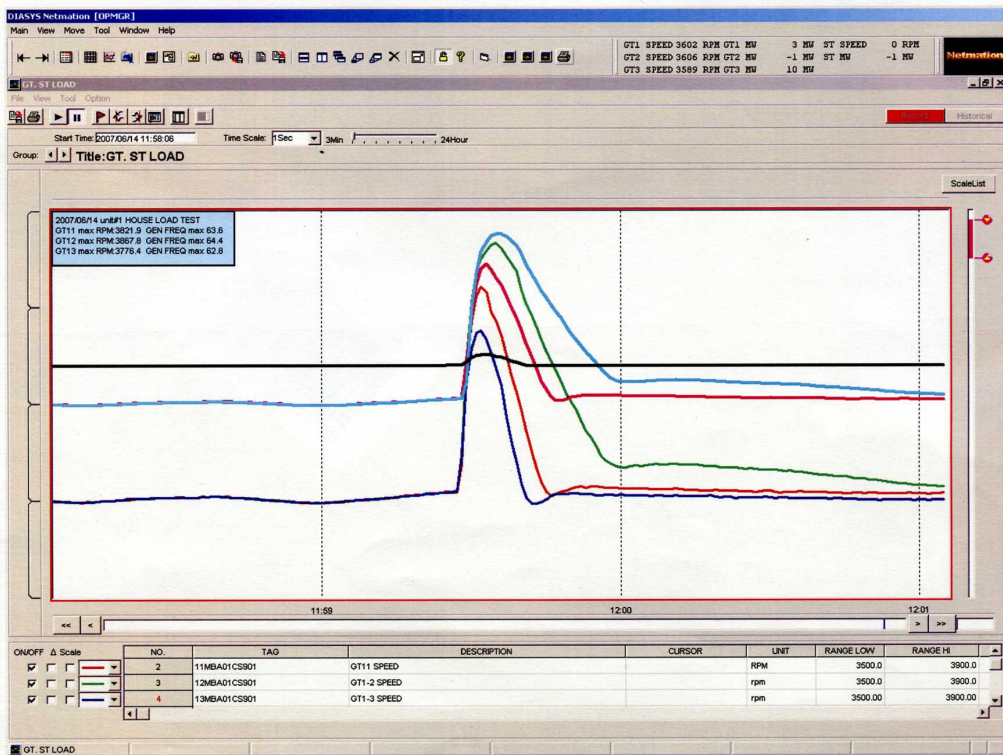
圖 17 一號機 House Load 運轉速度趨勢圖
