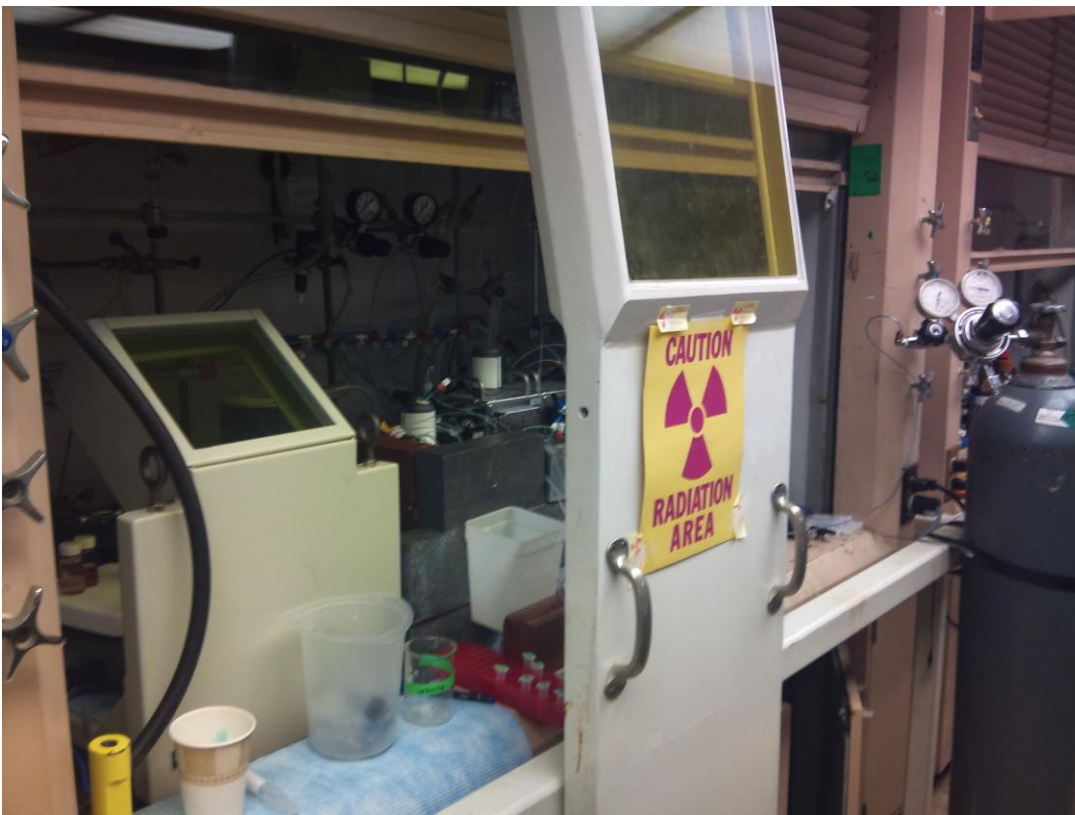
圖十、進行 ^{18}\text{F} FBEM 人工合成時使用之抽風櫃及防護屏蔽。
