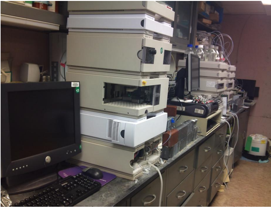
圖十二、分析級 radio-HPLC (Agilent)。
