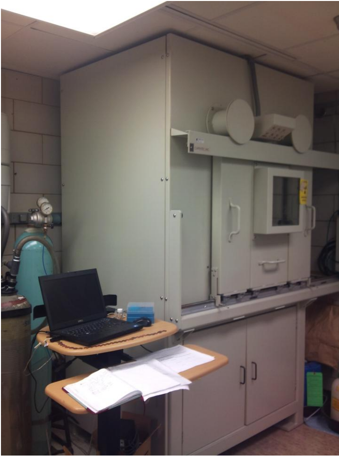
圖七、自動化合成系統之防護屏蔽及控制電腦。
