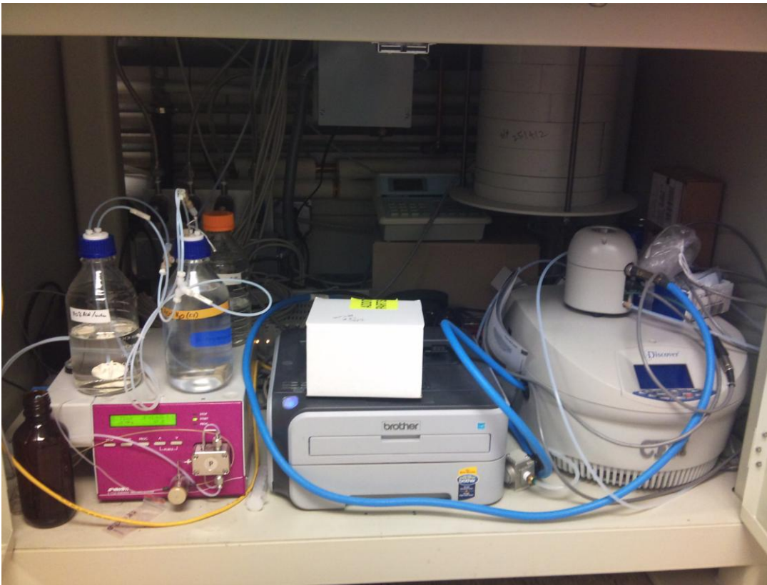
圖九、 ^{18}\text{F} FBEM 自動化合成系統之 radio-HPLC 純化系統。
