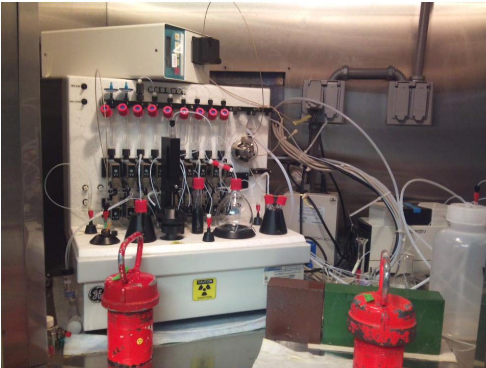
圖八、GE TRACERlab FX FN 自動合成盒。
