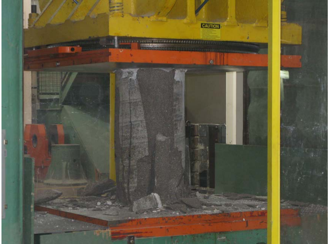
現場示範圓柱混凝土抗壓試驗
