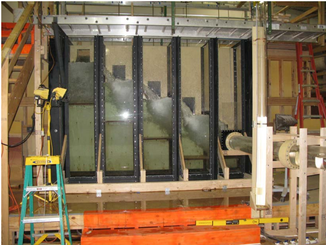
水工模型試驗一階梯式跌水消能
