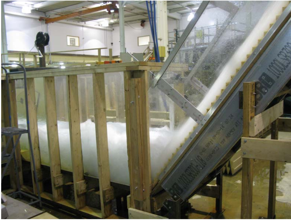
水工模型試驗－溢洪道設計
