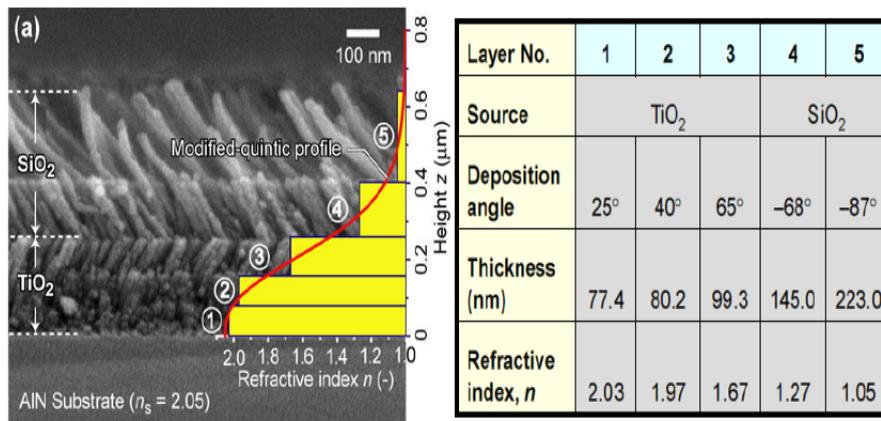
另外，若在 Si 基板上，使用多孔矽或是 TiO<sub>2</sub>/SiO<sub>2</sub> 的奈米線組合，可將反射率降至 0.1 以下，如下圖：
