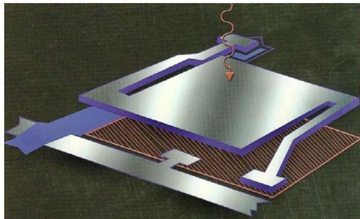
在製作上，可將 SWCNT 室溫熱像感測元件製程銜接於 CMOS 製程之後，因為 SWCNT 可以被清潔至相容於 CMOS 製作廠房的潔淨度需求，並且已有展示小於 17 微米平方之 SWCNT 室溫熱像感測元件仍有足夠的良率，甚至也有證據指出 SWCNT 元件不像氧化釩和非晶矽元件受限於 1/f 雜訊。下圖為將 SWCNT 應用於矽晶圓上以製作室溫熱像感測元件之系統:
