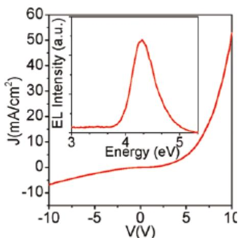
其發光能量在 4.3 eV 左右，換算成波長為 288 nm，顯示元件可操作在深紫外光區域，而電流-電壓特性則顯示啟動電壓約在 5 V 左右，略大於一般氮化鎵 LED 的 3 V，可能是由於氮化鋁的高能隙影響所造成。報告中亦提及可將此極化之氮化物奈米線技術擴展至氮化銦鎵材料，即可將發光波長向下延伸至可見光區域，亦可將此技術用於發展電晶體、光二極體、太陽電池等其他光電及電子元件。
