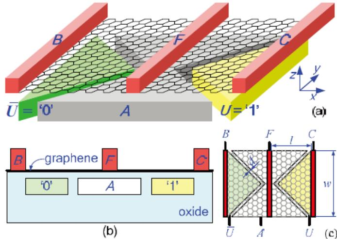
首先石墨烯薄片必須放置在一非常平整平面上以降低電子散射，若在電極上加一正偏壓，可將費米能階(Fermi level)提升至高於狄拉克點(Dirac point)，形成 N 型(圖中以‘1’表示)；反之，若在電極上加一負偏壓，則形成 P 型(圖中以‘0’表示)。因此，可利用可在三個電極上施加不同偏壓來形成邏輯運算，其運算模式如下圖表示
