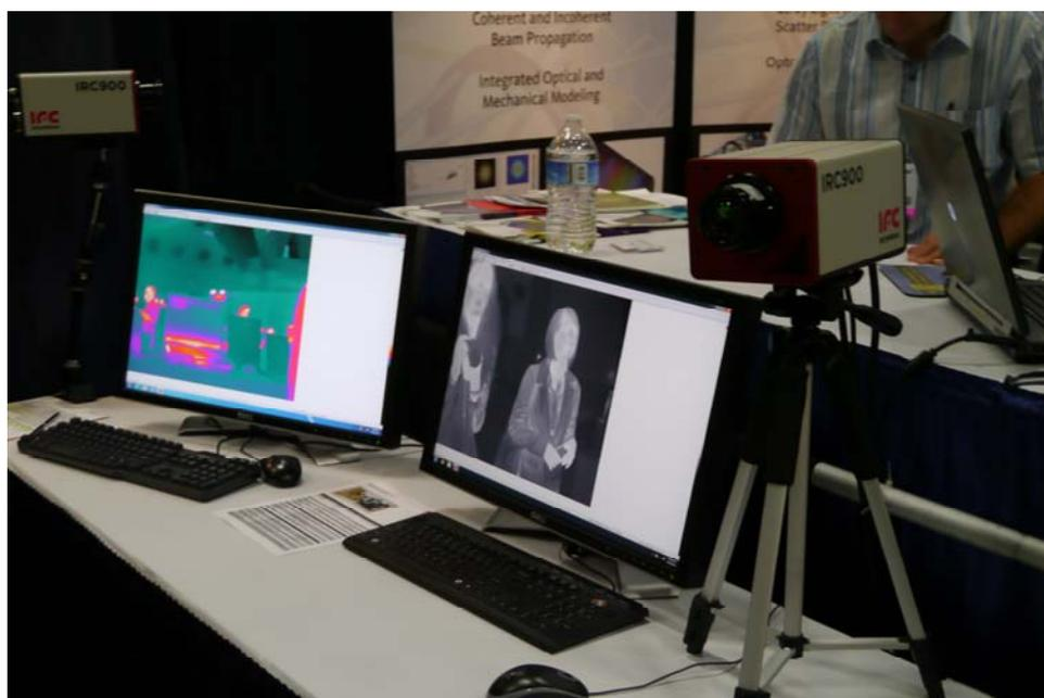
另一家 Xenics 公司現場展示之紅外線熱像機更為齊全，有短、中、長波段之致冷型紅外線熱像機，亦有室溫熱像模組與系統展示，其偵測器以非晶矽(amorphous-Si)製作，解析度為 640×480，其體積遠小於致冷型紅外線熱像機，現場亦有核心模組展示，體積只有 5(公分)X5(公分)X3(公分)左右，可作為系統整合，而室溫熱像影像亦非常清晰，下圖為室溫熱像實機照片，該公司相關產品型錄參照於附件三。
