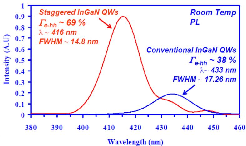
另外，若將量子井的銦含量提高，可將發光波長由藍光延伸至綠光，使用下列兩種量子井結構做比較，GaN / 27-Å In<sub>0.26</sub>Ga<sub>0.74</sub>N / GaN 與 GaN / 13-Å In<sub>0.28</sub>Ga<sub>0.72</sub>N / 13-Å In<sub>0.21</sub>Ga<sub>0.79</sub>N / GaN，在電子-電洞複合效率可由 26 % 提高至 35 %，而發光強度可提高 2 倍以上，如下圖所示。
