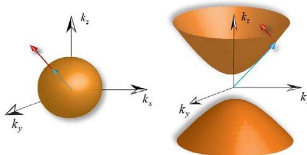
真空中圓形發散會導致一有限的態位密度，而異向性超材料則有一雙曲線發散關係可允許具有很大  $k$  值的波向量傳遞。實驗上在一金屬基板上以 PMMA 材料製作環形結構，在有效介質趨近下，此結構可產生一獨特的表面態位，將量子點放置在此環形結構內部，在光學灌注之下，可發現一螢光由量子點發射產生自發性放射現象，如下圖所示：
