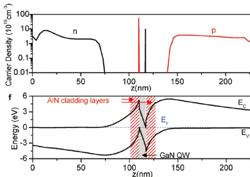
由能帶圖可清楚看到 N 型與 P 型區域形成與中間量子井主動層。奈米線的掃描式電子顯微鏡照片與其實際量測原子成分組成如下圖所示:
