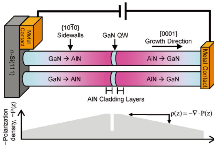
此結構可藉由極化效應在左側形成一 N 型區域, 右側形成一 P 型區域, 其載子濃度分布與能帶圖如下圖:
