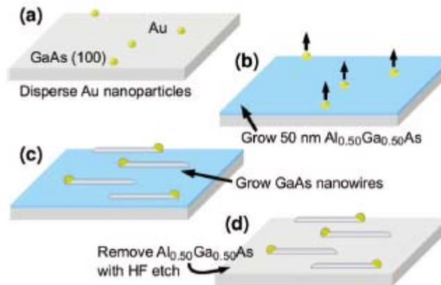
基本上先在基板上放置金觸媒(Au catalyst),首先在 625 °C 成長一層 AlGaAs 犧牲層,厚度約 25~50 nm,接著在 460 °C 成長 GaAs 奈米線,最後再用氫氟酸將 AlGaAs 犧牲層移除,如此可將奈米線與基板分離,但仍同時保持一致的排列方向,如下圖所示,圖中黑色箭頭所指即為 AlGaAs 犧牲層。
