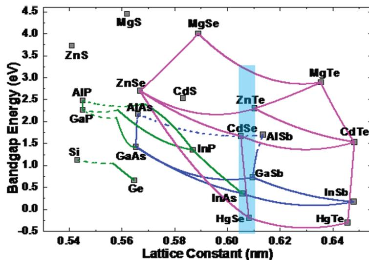
報告亦提出可在 Si 基板上利用 MBE 成長低缺陷 ZnTe 薄膜，其 ZnTe 薄膜 XRD 半高寬可小於 70 arcsec，蝕刻孔密度(etching pits density, EPD)小  $10^5 \text{ cm}^{-2}$ ，因 ZnTe 晶格與 HgCdSe 匹配，可以此複合基板來生長高品質 HgCdSe 薄膜以製作紅外線元件。
