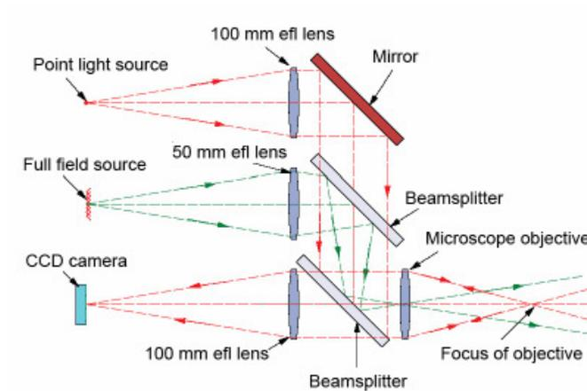
實際應用上，先對焦在一平面獲得一參考點，移動顯微鏡並聚焦在一校正基準面，通常為一球形體，並形成聚焦，將球形體移開，放上待測鏡片或鏡面，調整直到光線聚焦在中心點，以下為一校正稜鏡示意圖。
