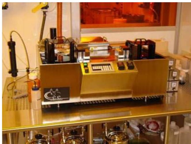
SWCNT 的製作使用一高真空的化學氣相沉積系統(Cheical Vapor Deposition, CVD)來成長，系統設備圖如下：
