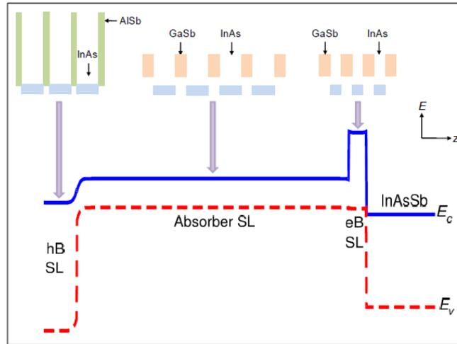
報告中亦提到其元件之位障阻擋層均為單極性位障(unipolar barrier)，意思為阻擋單一極性載子，亦即電洞位障只會阻擋電洞，電子位障只會阻擋電洞，可增加元件效率。在 0.2 V 偏壓下，元件漏電流密度為  $1 \times 10^{-5}$  A/cm<sup>2</sup>，響應度(Responsivity)為 1.5 A/W，偵測度 (Detectivity)為  $1.1 \times 10^{11}$  cm-Hz<sup>1/2</sup>/W，吸收波長為 8.2  $\mu$ m，其漏電流特性已可與 MCT 偵測器媲美。此外，該團隊亦將此位障紅外線偵測器元件製作成 1024 $\times$ 1024 焦平面陣列(focal plane array, FPA)，其影像品質如下所示。
