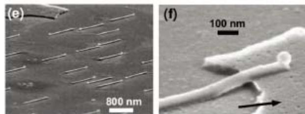
報告中亦提及若要製作相同間隔之奈米線陣列,則必須電子束顯影技術(e-beam photolithography)將金觸媒整齊排列在基板上,再利用 MOCVD 生長,即可得到排列整齊之奈米線陣列。在電子元件製作上,可在 GaAs 奈米線生長後成長一層 AlGaAs,由於 AlGaAs 能隙大於 GaAs,可在介面形成具有高電子遷移率之二維電子氣結構(2 dimensional electron gas, 2DEG),並且由於奈米線本身具有低缺陷密度,可減少漏電流行程途徑,因此可製作特性良好之電子元件。
