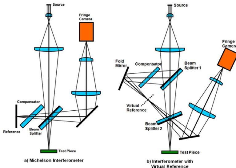
最後利用此一干涉儀所量測的物體表面粗糙度，在無高通過濾情形下可小於  $1 \text{ \AA}$ ，再加上高通過濾後，其粗糙度可小於  $0.2 \text{ \AA}$ 。
