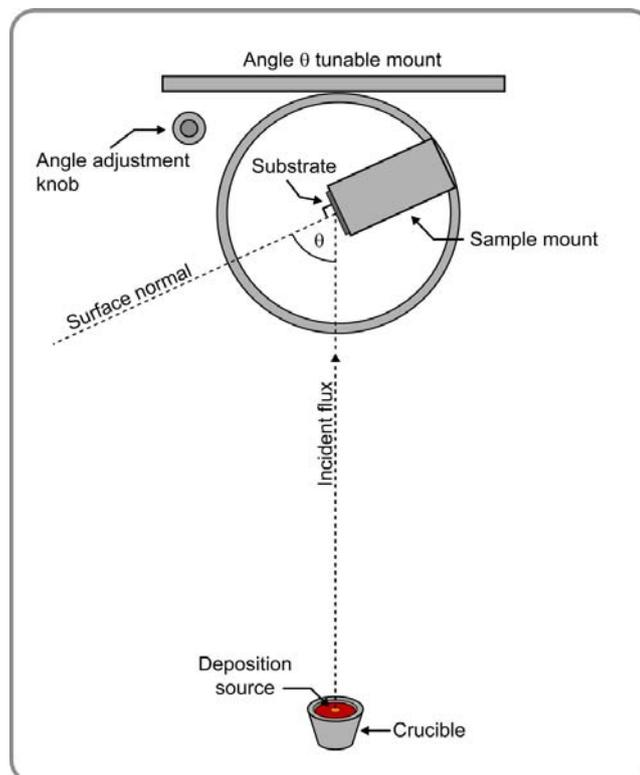
將所要蒸鍍材料放於坩鍋內，再以電子槍蒸鍍方式將奈米線/奈米柱鍍於材料表面，其奈米線/奈米柱成長方式以下圖表示:
