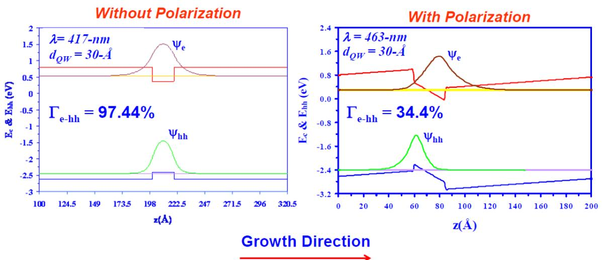
因此，為提高電子-電洞複合效率，將量子井內的單一組成 InGaN 層改為具有兩種組成之 InGaN 層，在實驗上使用 GaN / 25-Å In<sub>0.15</sub>Ga<sub>0.85</sub>N / GaN 與 GaN / 7.5-Å In<sub>0.25</sub>Ga<sub>0.75</sub>N / 7.5-Å In<sub>0.15</sub>Ga<sub>0.85</sub>N / GaN 兩種量子井結構作比較，此結構之發光波長在 420~430 nm 左右，由下
