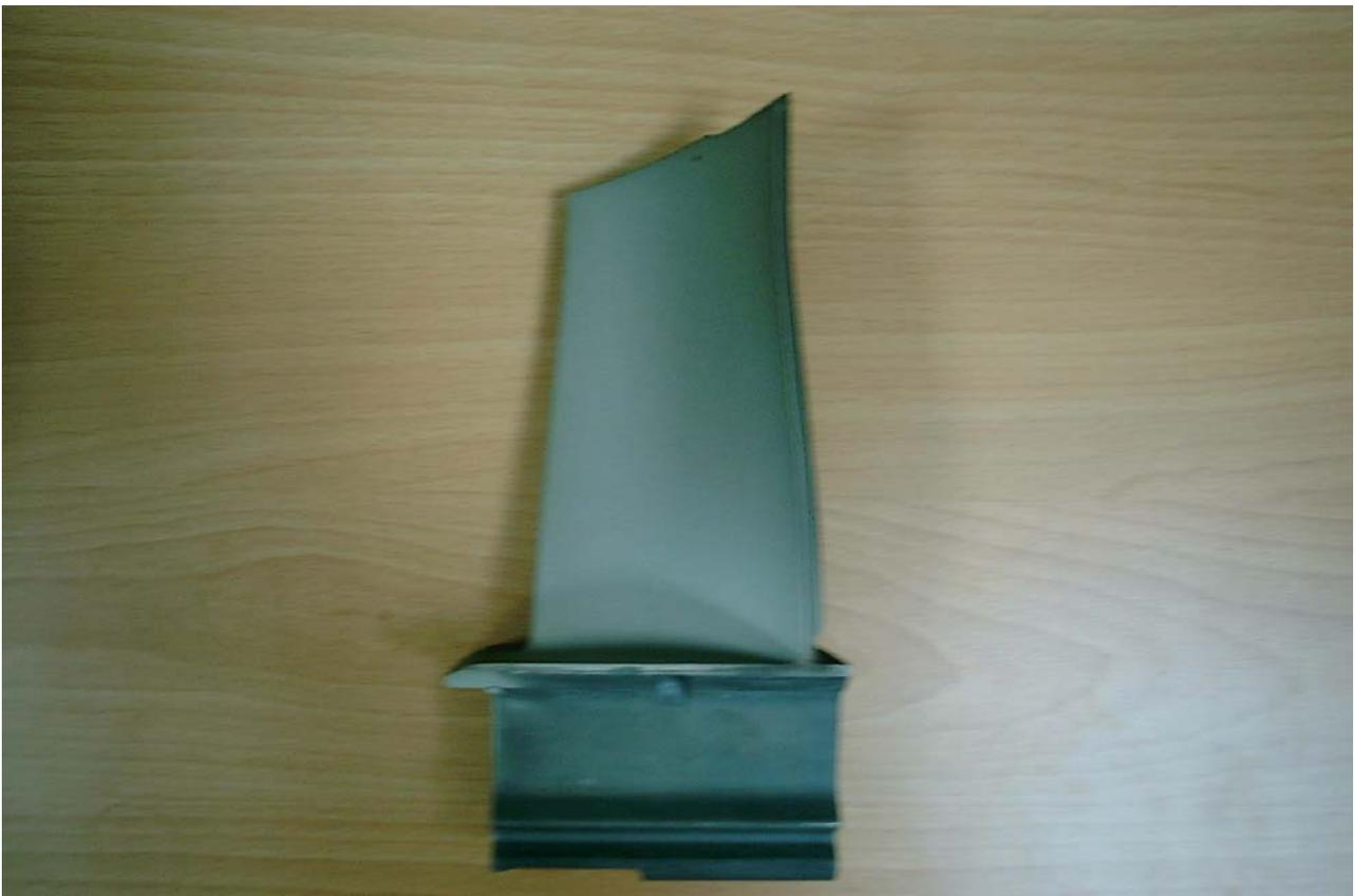
圖十二 發電機葉片—一級動葉
