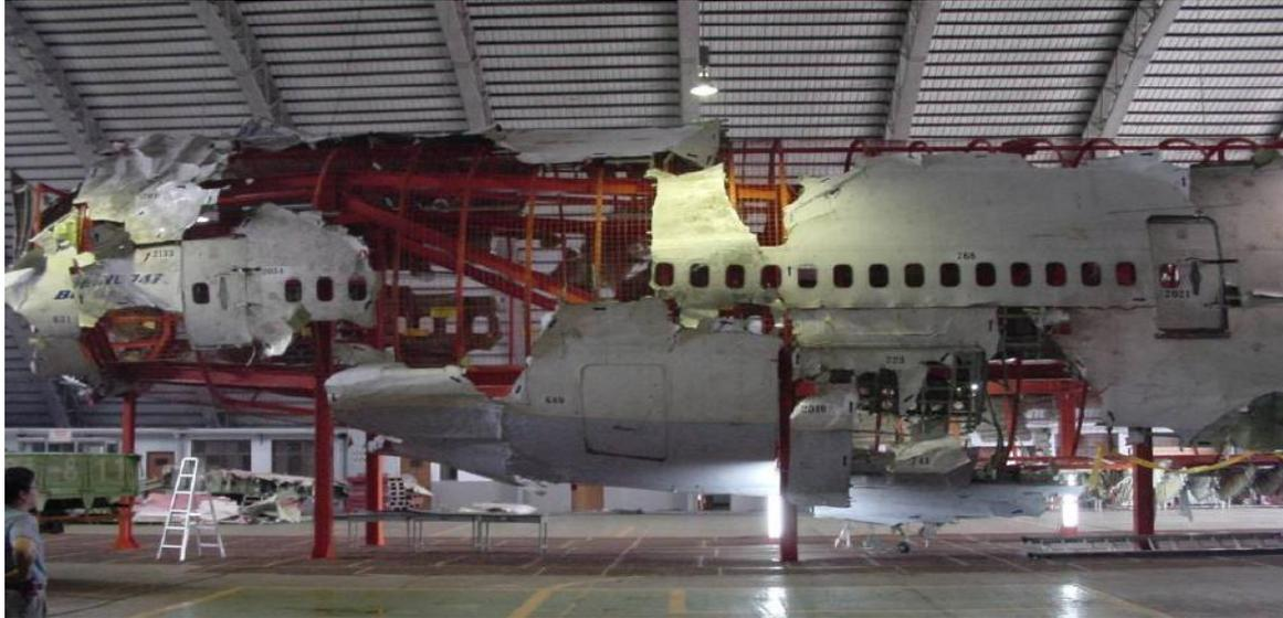
圖 2.3.2-5 波音 747 後段機身殘骸 3D 重組成
