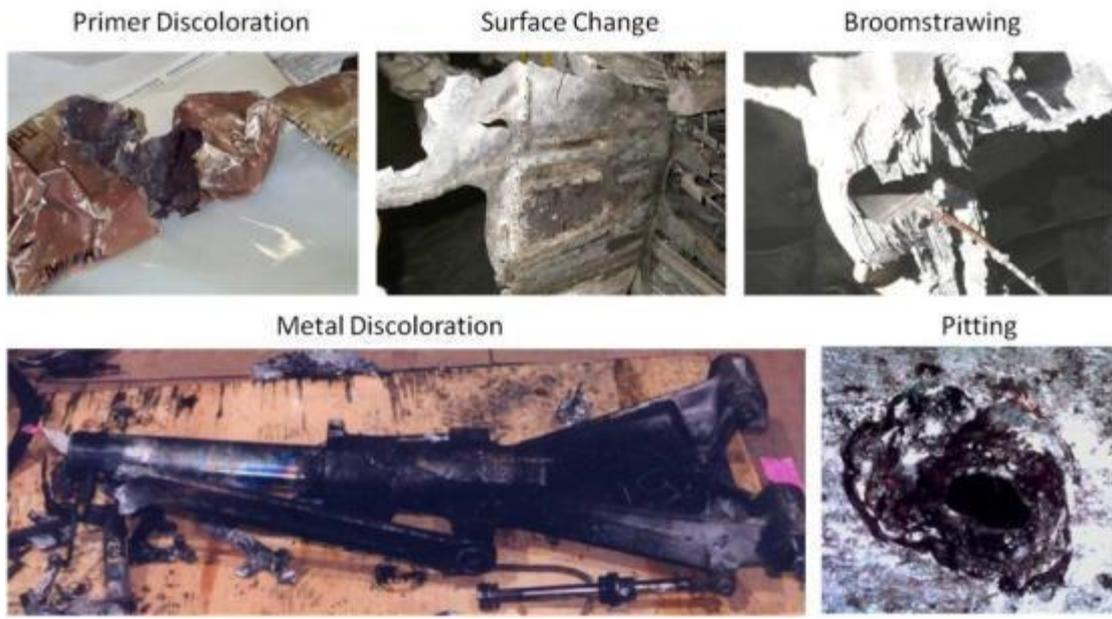
圖 2.3.8-3 殘骸受熱造成之損壞情形
