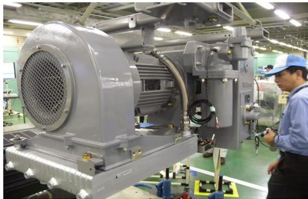
圖 3 空壓機調移至試驗台
