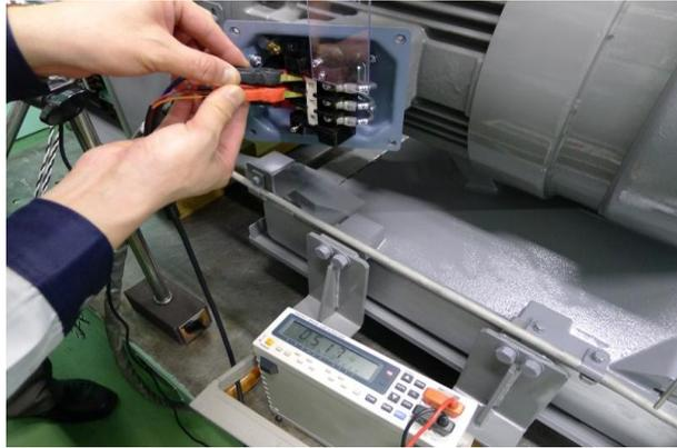
圖 8 量測空壓機馬達相間阻抗 (3 相平衡)
