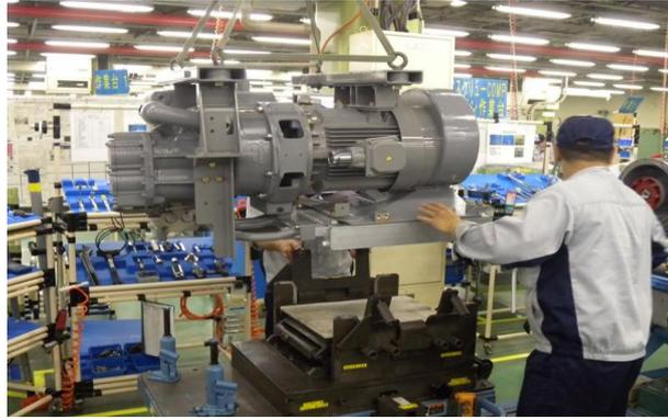
圖 2 空壓機調移至試驗台
