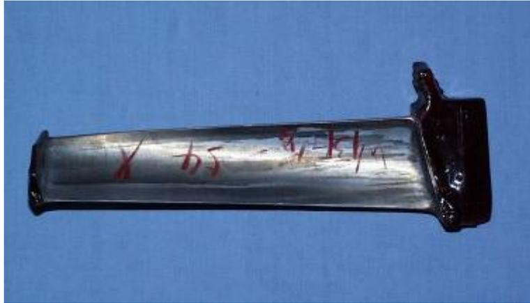
圖 20 某型號發動機斷裂葉片
