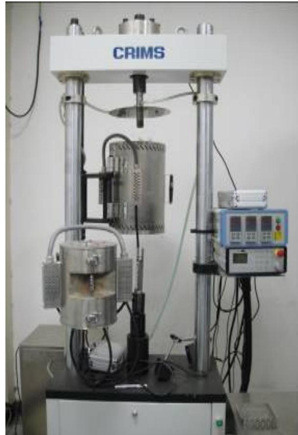
圖 11 材料高溫潛變-疲勞動態行為試驗機
