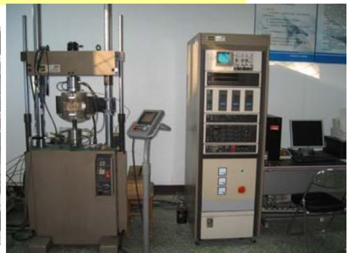
挂块金属的拉伸性能测试
