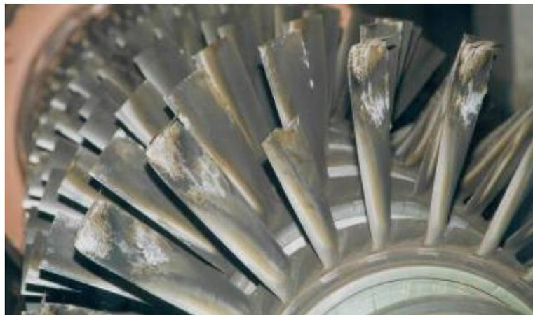
圖 21 催化裂化裝置軸流主風機葉片斷裂
