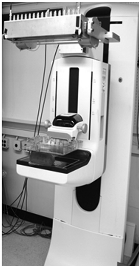
圖十、靜態數位式乳房攝影斷層合成掃描儀
