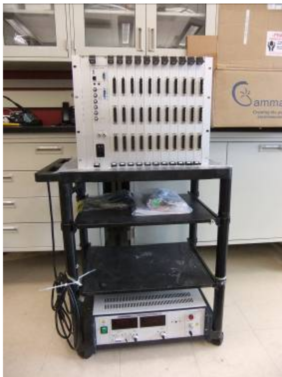
圖十九、新一代多通道陣列式奈米碳管 X 光源陰極高壓控制模組
