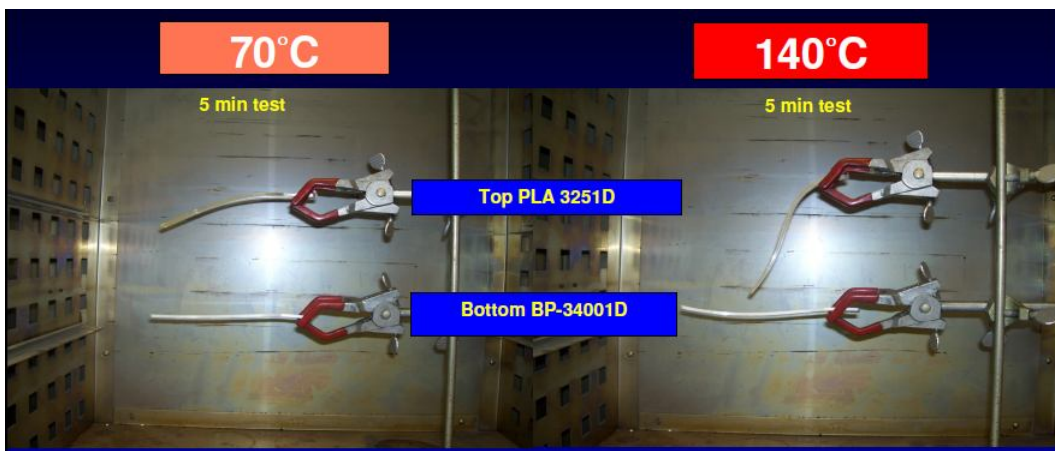
圖六 PLA 熱穩定性測試，上為 PLA，下為經過添加強化熱穩定的 PLA
