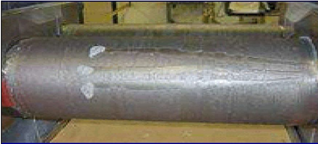
圖五 PLA 在金屬模具表面上的沾黏
