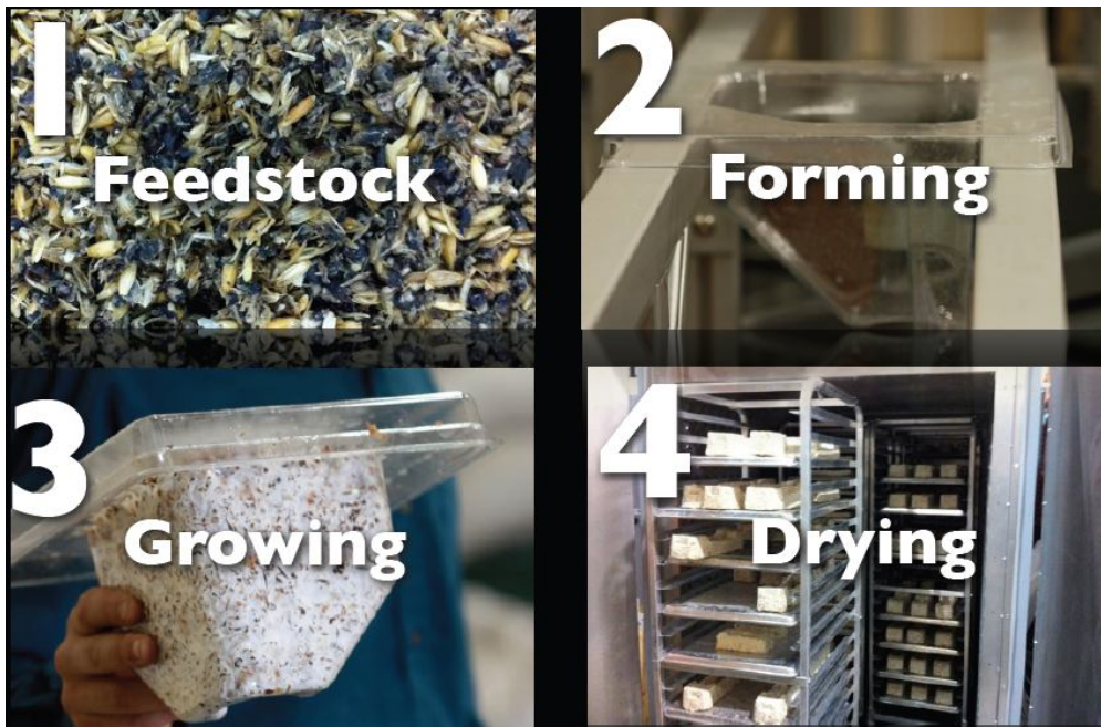
圖四十三 Ecovative 新型蘑菇真菌菌絲體塑膠材料製造四步驟
