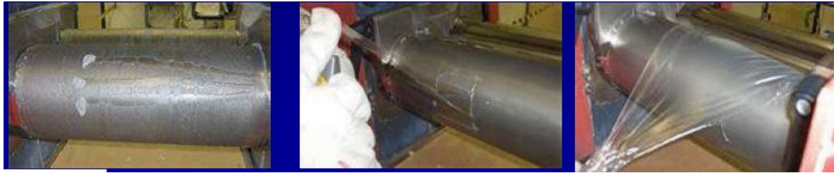
圖二十五 聚乳酸未加入脫模劑(左)及加入 3%(中)、5%脫模劑(右)之拉出效果
