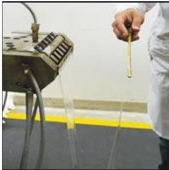
圖四 熔體強度測試，PLA 在拉出以後會迅速垮下
