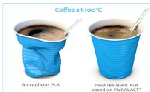
圖十七 一般 PLA 和 PURAC 公司開發之新型聚乳酸裝 100 °C 咖啡的差異
