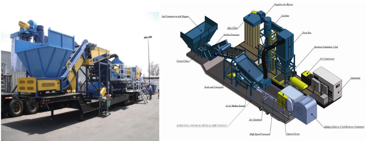
圖四十五 Future 500 分揀機外觀和構造圖
