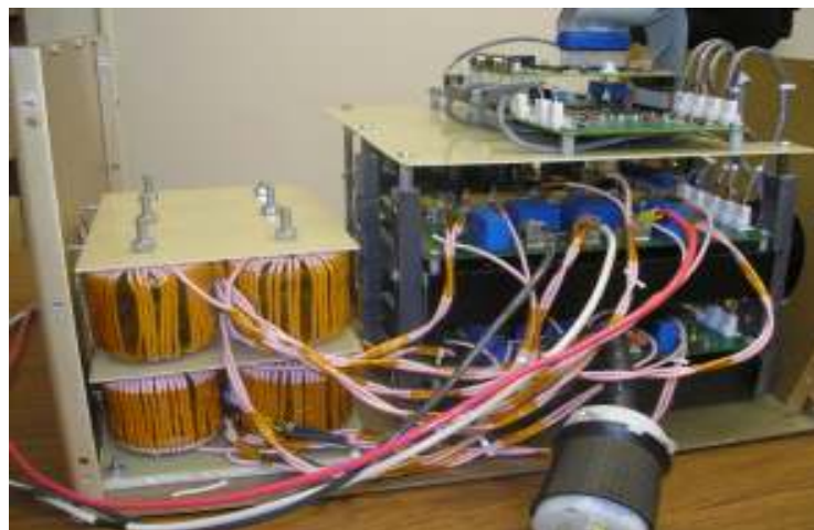
圖三十五、含 DSP 控制之三相背對背交/直/交流電力轉換器
