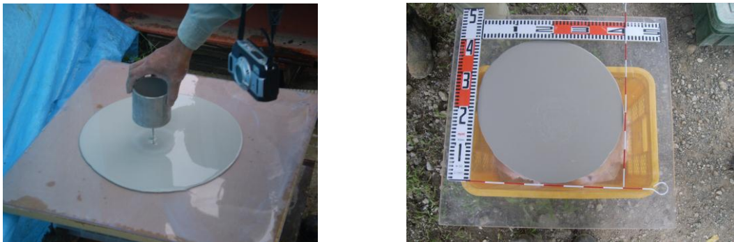
圖 4 流動值測定，流動值品管標準 350~450mm
