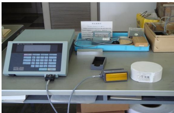
圖 3 熱傳導率測量〔4〕(非定常熱線法)
