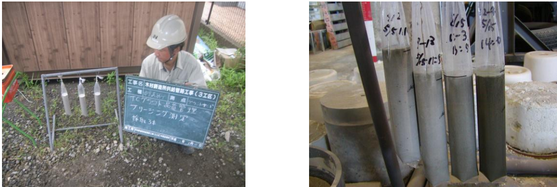
圖 5 填充材料體積變化測量，於灌注 24 小時後之浮水率須 <1\%
