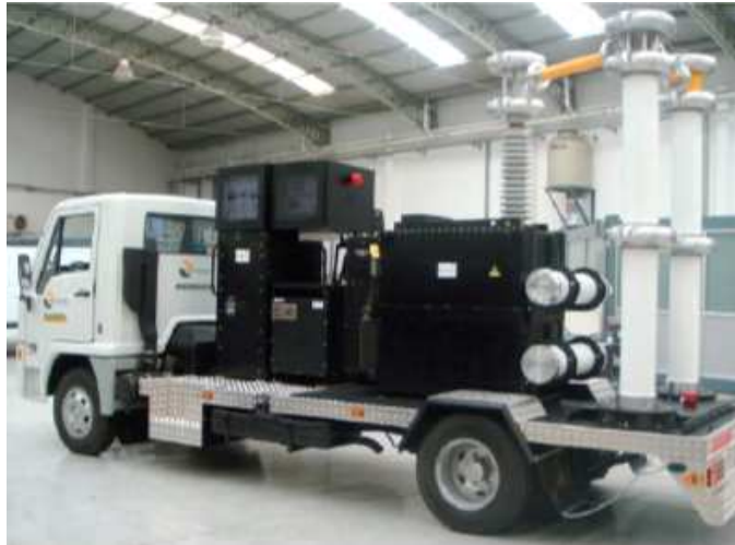
圖 4： 200kV 極低頻耐壓暨部分放電測試車
