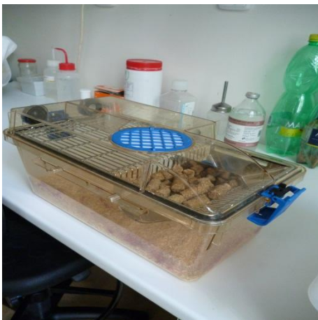
無菌鼠房中的無菌操作隔離台，裡面為獨立飼養隔離箱系統
