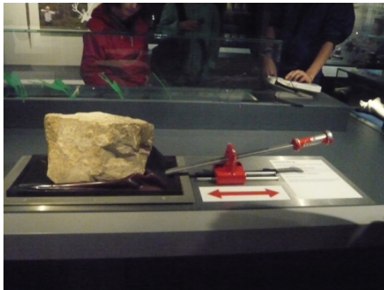
牛津大學博物館展示力學原理中第一種槓桿輔助教學模型，藉由改變力臂長度來瞭解影響施力之大小
