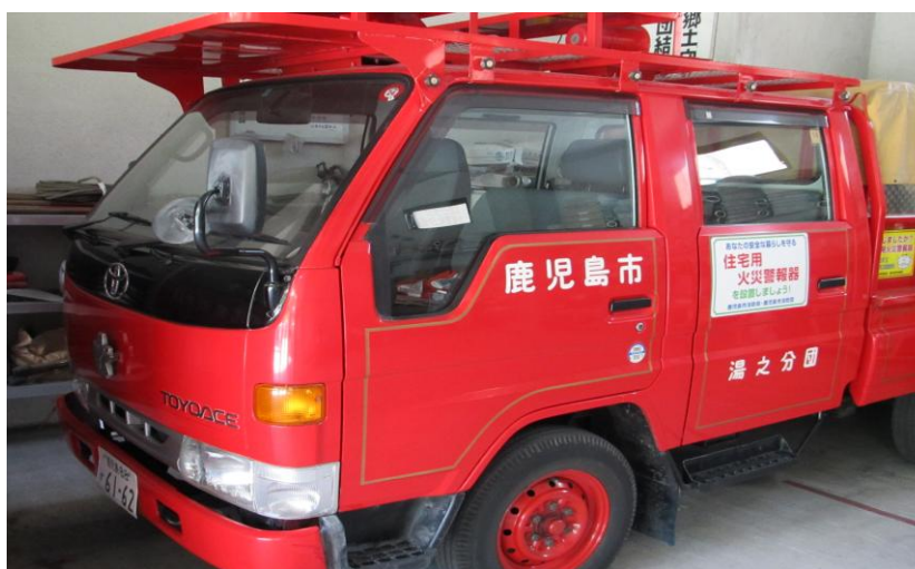
圖 35 櫻島內湯之分團隊部消防車，車頭加裝防止火山掉落物遮版(資料來源：本考察整理)
