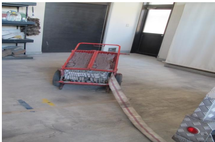
圖 45 櫻島西消防分遣隊水帶車，可迅速於巷弄間延伸水帶(資料來源：本考察整理)
