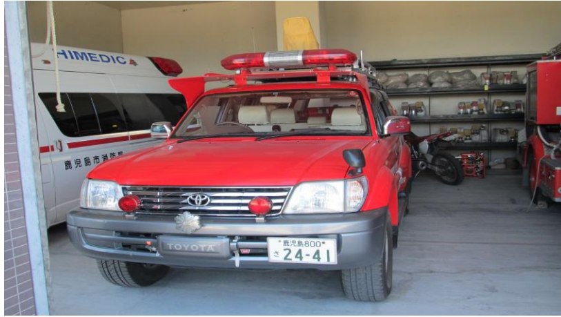
圖 43 櫻島西消防分遣隊指揮車，於車頂加裝防止火山灰掉落物遮板 (資料來源：本考察整理)
