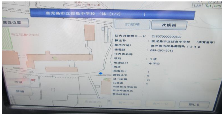
圖 50 櫻島西消防分遣隊消防車裝台派遣系統上甲種搶救圖功能(資料來源：本考察整理)
