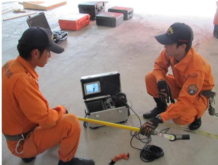
圖 56 鹿兒島市消防局訓練中心展示生命探測器(資料來源：本考察整理)
