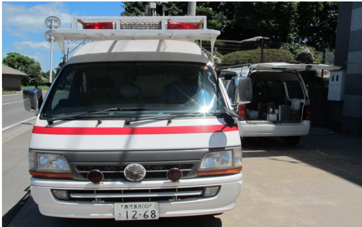
圖 52 櫻島西消防分遣隊救護車，於車頂加裝防止火山灰掉落物遮板 (資料來源：本考察整理)
