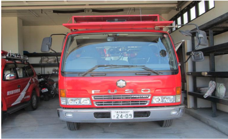
圖 46 櫻島西消防分遣隊消防車，於車頂加裝防止火山灰掉落物遮版 (資料來源：本考察整理)
