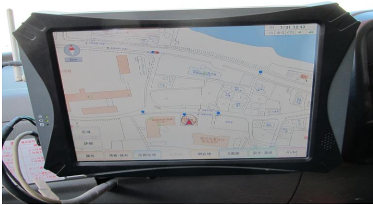
圖 47 櫻島西消防分遣隊消防車裝台派遣系統的 GPS 導航功能(資料來源：本考察整理)
