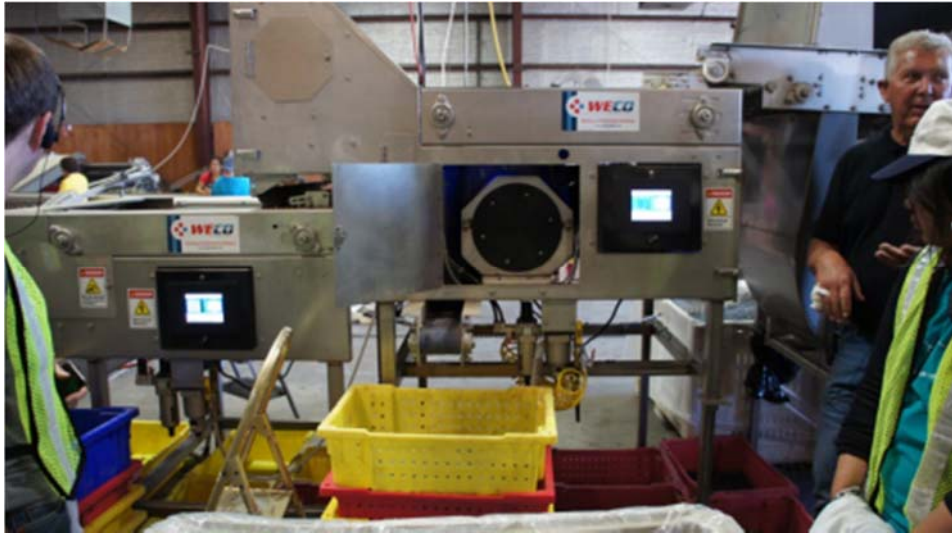
圖 41. 雷射選別機可依據果實尺寸與品質進行兩次選別
