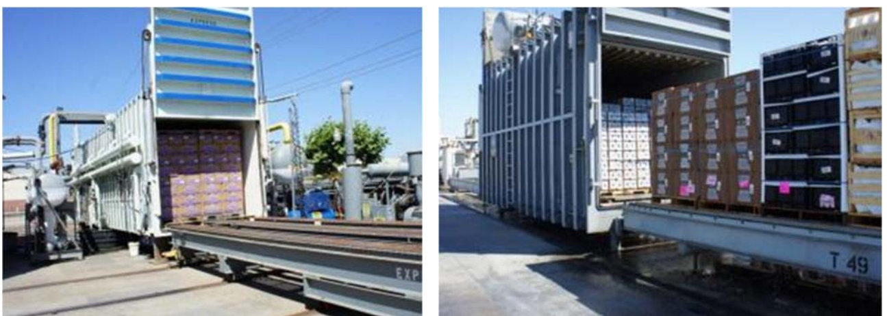
圖 21,22. 圖 21 為傳統真空預冷 圖 22 則為新式灑水後再行真空預冷設備，可看出處理完後之地面上有水滴落（拍攝於 Ocean Mist company）
