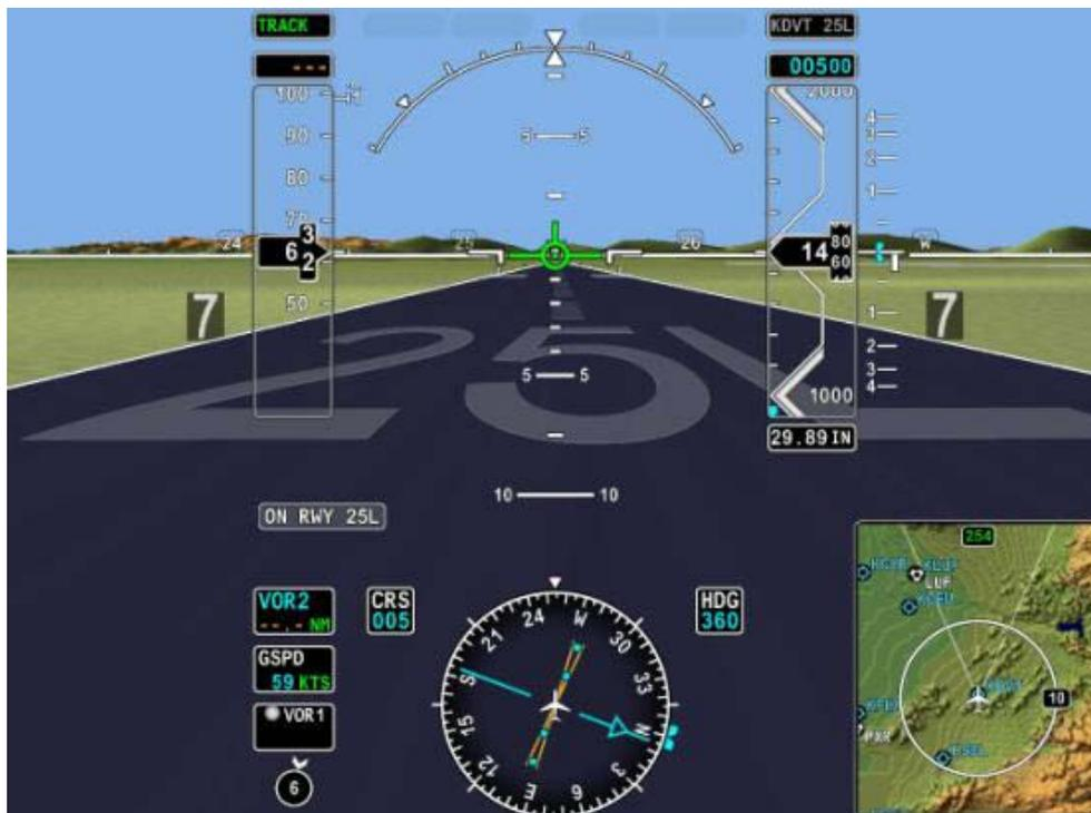
圖 3.6 Primus EPIC 導航模組顯示系統（適用於 Gulfstream 機種）
