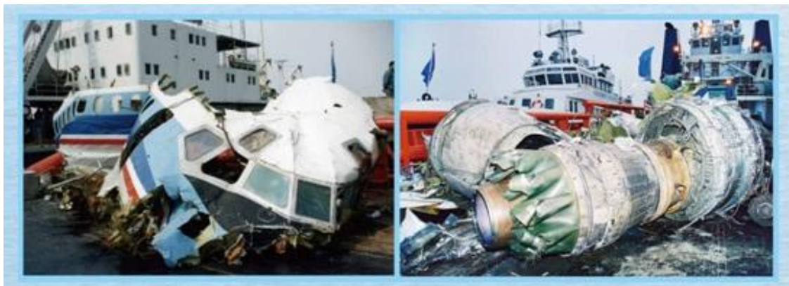
圖 7 大陸地區水下殘骸打撈案例-MD-82 客機大連附近海域失事殘骸
