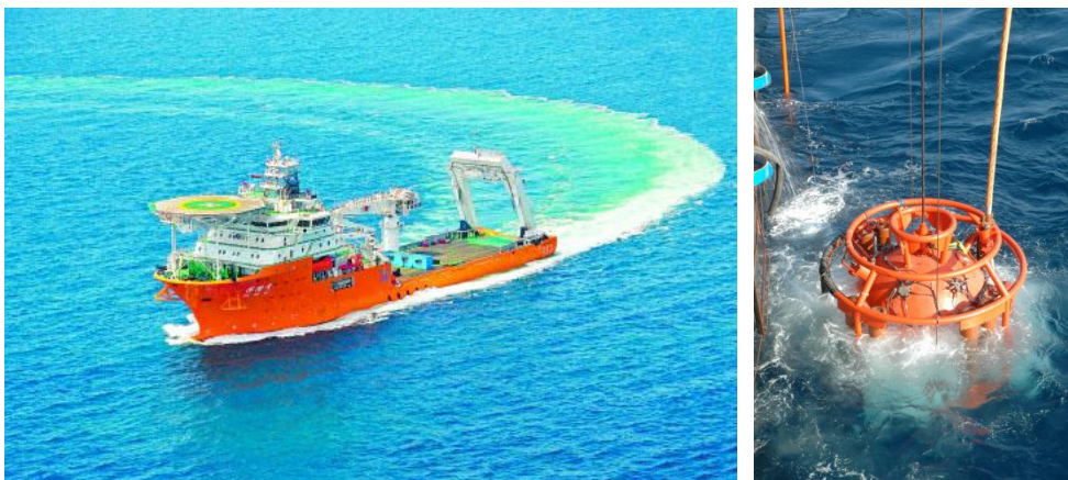
圖 6 大陸地區深潛號-搭載最先進的飽和潛水系統
