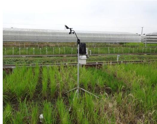
圖八、耐旱試驗田區之風向及風速測儀
