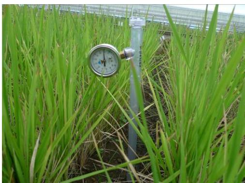
圖五、耐旱試驗田區之土壤水分張力計
