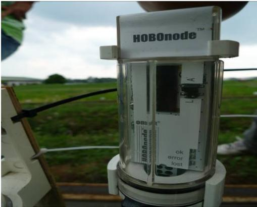
圖七、耐旱試驗田區之土壤溫、濕度無線傳感器
