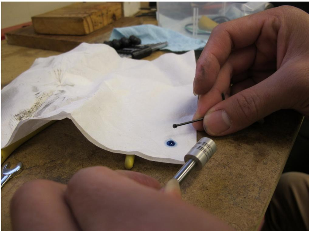
圖 二十一、撓性軸耦合器螺紋防鬆膠處理
