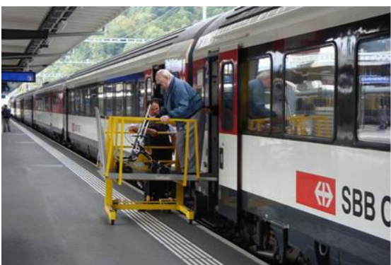
圖254.無障設備操作情形(月台落差)
