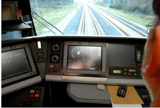
圖124. Level 2車載號誌
