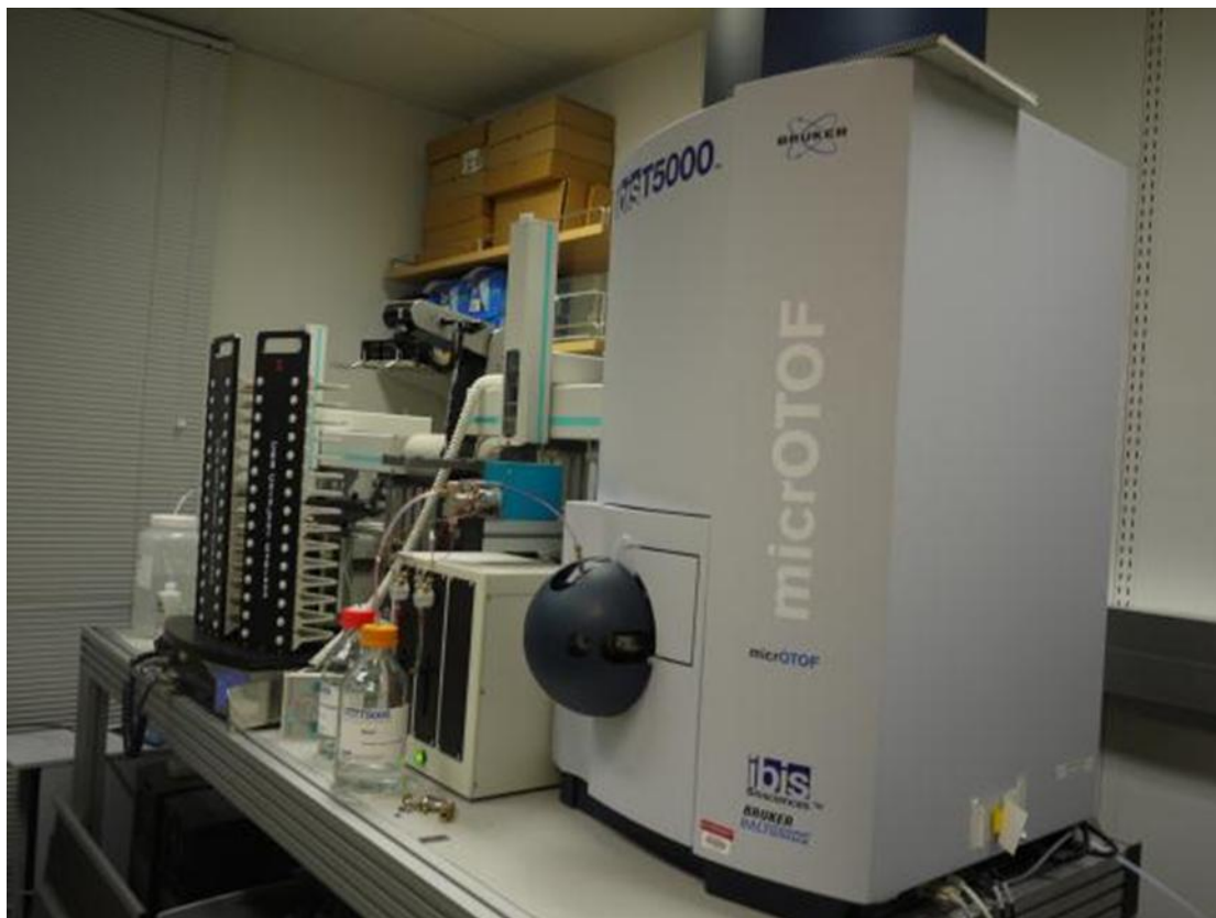
圖 23. Ibis T5000 生物感應器可迅速識別新型微生物
