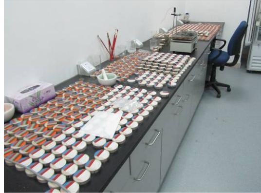
圖 50：保護研究所以礦物顏料製作樣品，模擬壁畫各種損壞情形以利研究與修復
