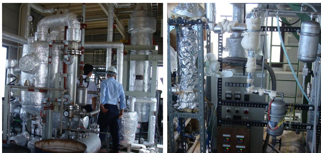
圖十一、Daiki Axis 測試之固態觸媒製程:
